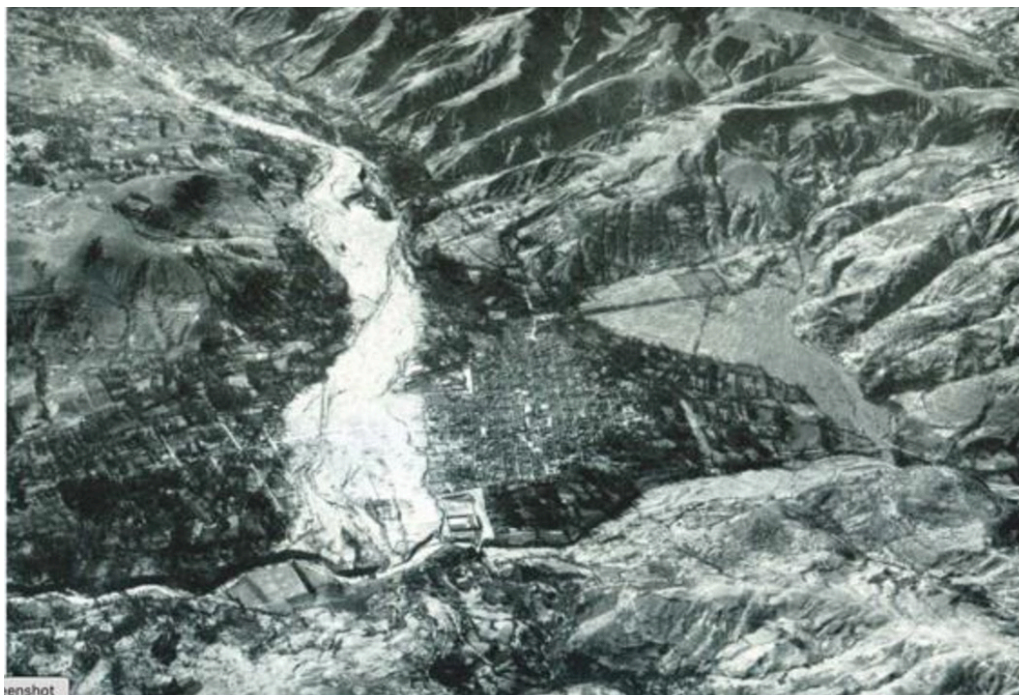
Fotografía N° 2: Huella del aluvión de 1941 en la ciudad de Huaraz, originado en desprendimiento de morrenas laterales sobre la laguna Palcacocha.
