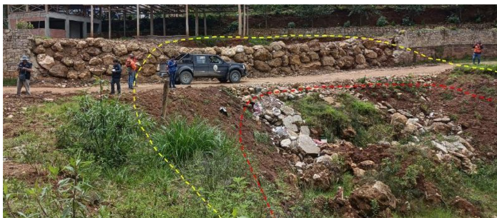
Figura 20. Vista del escarpe principal (en amarillo) y del secundario (en rojo) del deslizamiento DRA3. Coordenadas: E: 182914; N: 9308921; Z: 2405.
