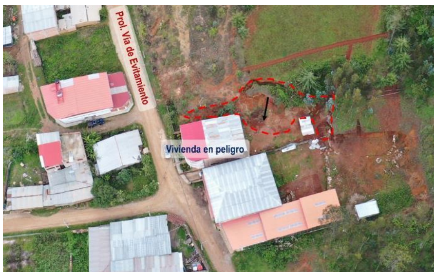
Figura 22. Vista del derrumbe activo DA1 que pone en peligro a una vivienda ubicada en su parte inferior.
