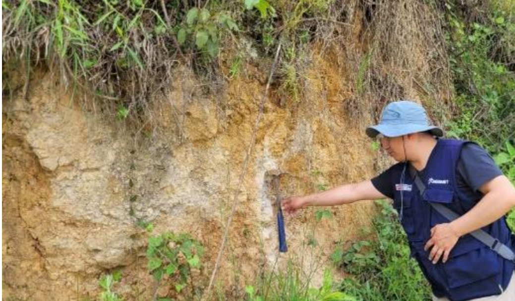
Fotografía 1. Niveles de conglomerados muy fracturados y altamente meteorizados de la Formación Inguipata. Coordenadas: E: 181978, N: 9309253, Z: 2290.
