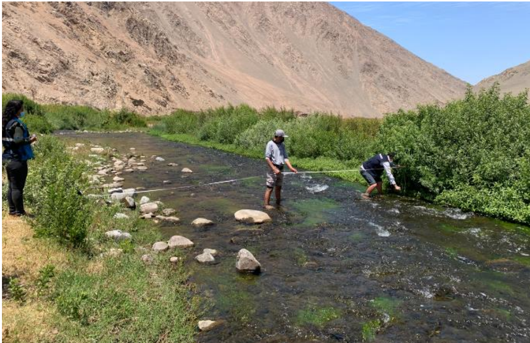
Fotografía N° 47: Aforo N° 01 del río Ilo – Osmore, con 523 L/s.
