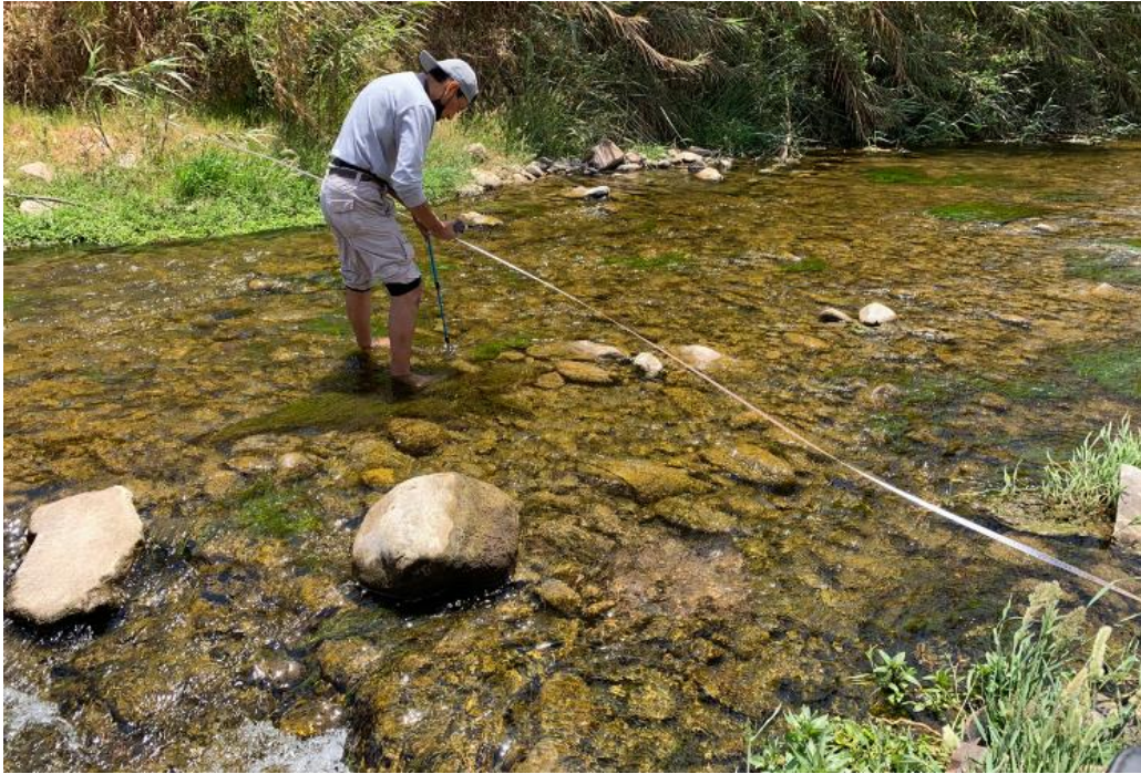
Fotografía N° 48: Aforo N° 02 del río Ilo – Osmore, con 363 L/s.
