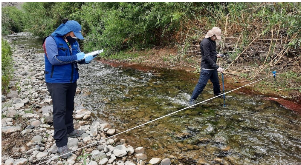
Fotografía N° 50: Aforo N° 04 del río Ilo – Osmore, con 251 L/s.
