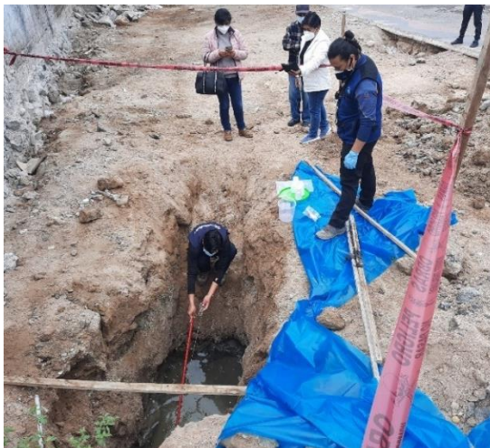
Fotografía N° 44: Trabajos de muestreo luego de la deposición de los sedimentos.
