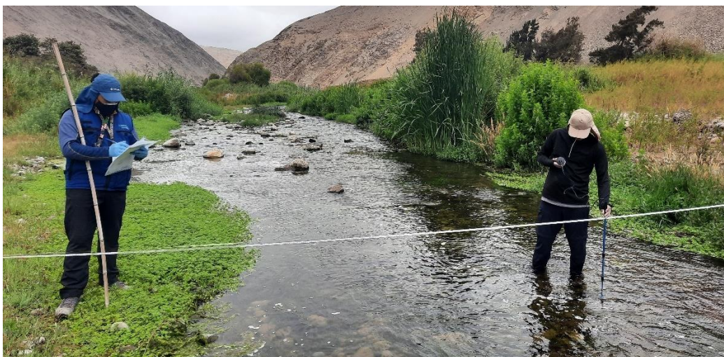
Fotografía N° 49: Aforo N° 03 del río Ilo – Osmore, con 243 L/s.
