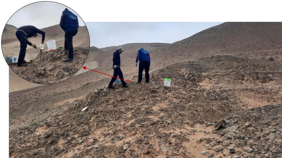
Figura N° 10: Corresponde al ensayo de infiltración E-007, en la Súper Unidad Ilo, donde los descensos de la infiltración del agua llegaron a medir hasta 40 cm de altura, considerándolo como un sector permeable.
