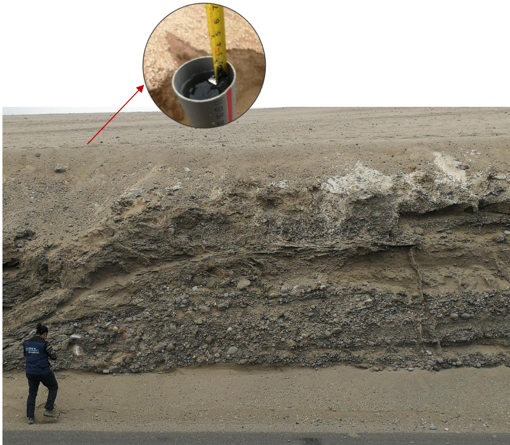
Figura N° 07: Corresponde al ensayo de infiltración E-002, nótese los diferentes niveles de estratos de arenas sueltas entre finos, medios y granos gruesos con grabas con cuerpos redondeados y subangulosos de hasta 15 cm de diámetro, y estratos de material limo arcilloso, que dan lugar a las barreras impermeables, en los círculos se observa el desarrollo del ensayo y la baja infiltración de la tasa de recarga por el tubo.
