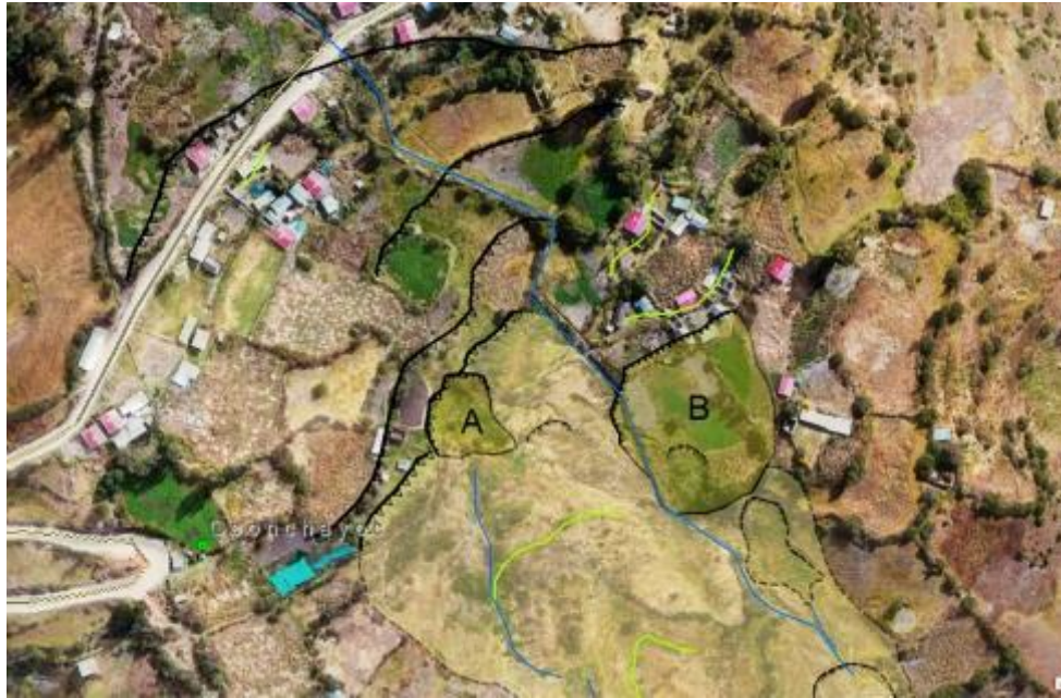
Figura 5: Se aprecia los polígonos en color amarillo oscuro que son los deslizamientos reactivados recientes A y B y en amarillo claro el deslizamiento del 2011.
