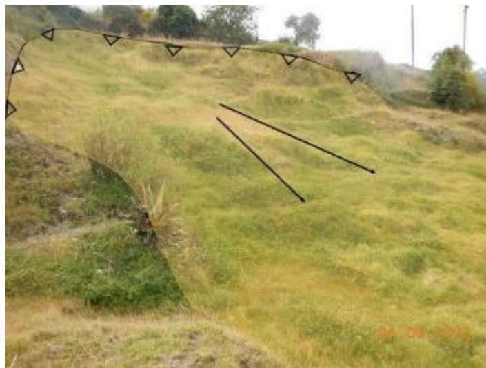
Figura 11: En la parte baja del deslizamiento principal se aprecia un movimiento de menor volumen generado el 2011.
