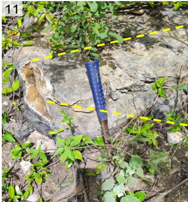
Figura 11 y 12. En el terreno evaluado se observa calizas nodulares moderadamente meteorizadas, medianamente fracturada. Coordenadas: Coordenada UTM WGS-84, 17S: E: 777738; N: 9386240.
