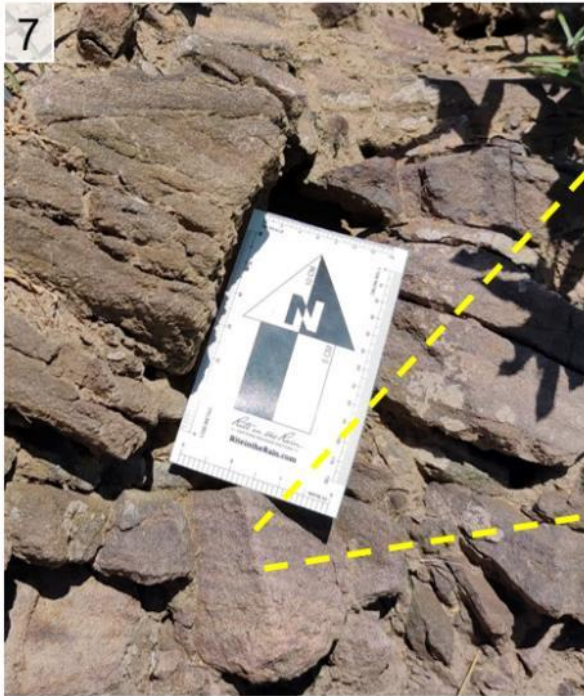
Figura 7 y 8. En el terreno evaluado se observa areniscas de grano fino a grueso de color rojizo, moderadamente meteorizada y muy fracturada. Coordenadas: UTM WGS-84, 17S: E: 775981; N: 9386035.
