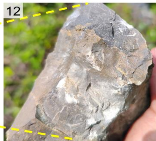
Figura 11 y 12. En el terreno evaluado se observa calizas nodulares moderadamente meteorizadas, medianamente fracturada. Coordenadas: Coordenada UTM WGS-84, 17S: E: 777738; N: 9386240.
