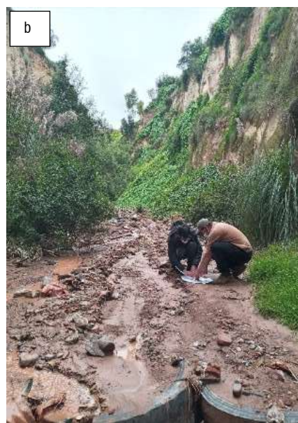
Imagen N° 20: Depósitos proluviales en los cauces de las quebradas. (a) materiales de gravas, con matriz limoso y presencia de basura. (b) presencia de materiales de grava con matriz limoso y presencia de llantas.
