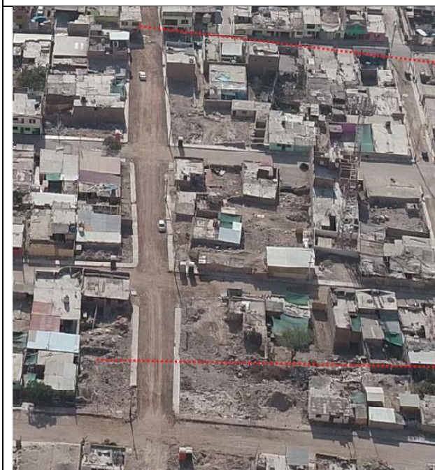
Imagen 67: (A) Se aprecia el estrechamiento de la calle al existir una vivienda que fue un obstáculo para el paso del huico. (B) Vivienda destruida por el flujo de detritos del 07 de febrero del 2019.
