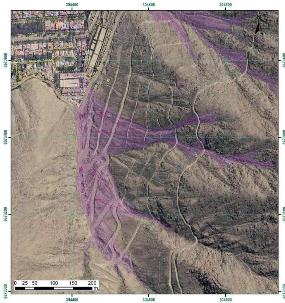
Figura 8. Depósitos de flujos de detritos antiguos ubicado al sureste de las manzanas I y H de la urbanización El Cuadro.
