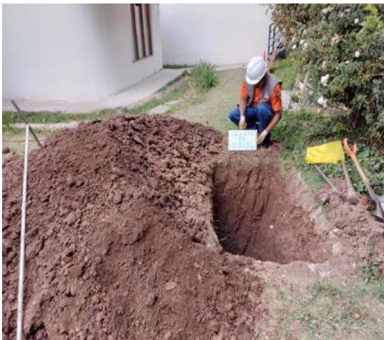
Foto N°7 Calicata 1 de arcilla de plasticidad media arenosa
