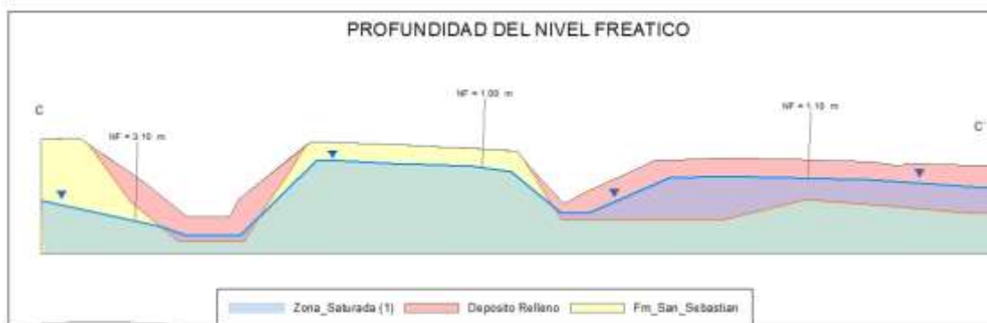
GRÁFICO N° 22 PROFUNDIDAD DEL NIVEL FREÁTICO DE 8.0 M A 15.0M
