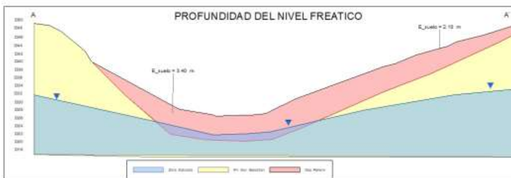
GRÁFICO N° 21 PROFUNDIDAD DEL NIVEL FREÁTICO DE 4.0 M A 8.0 M.
