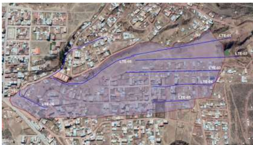
GRÁFICO N° 18 UBICACIÓN DE LOS PERFILES DE TOMOGRAFÍA ELÉCTRICA EN DIRECCIÓN W-E.
