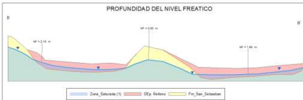
GRÁFICO N° 20 PROFUNDIDAD DEL NIVEL FREÁTICO DE 2.0 M A 4.0 M
