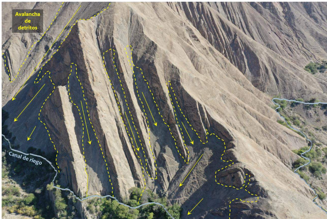
Figura 26. Se observa la acumulación de avalancha de detritos en las vertientes de la montaña (cerro Joto Jahuana). Estos fragmentos de rocas que ceden continuamente rellenan el canal de riego.
