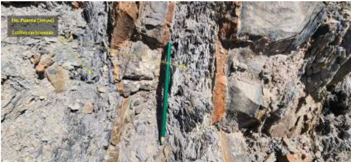
Figura 8. Sustrato rocoso de la Formación Puente – Sector Joto Jahuana. Muestra afloramientos de lutitas carbonosas moderadamente meteorizadas y fragmentadas (con espaciamientos menores a 5 cm). Estas se muestran astillosas y se separan lascas con facilidad.
