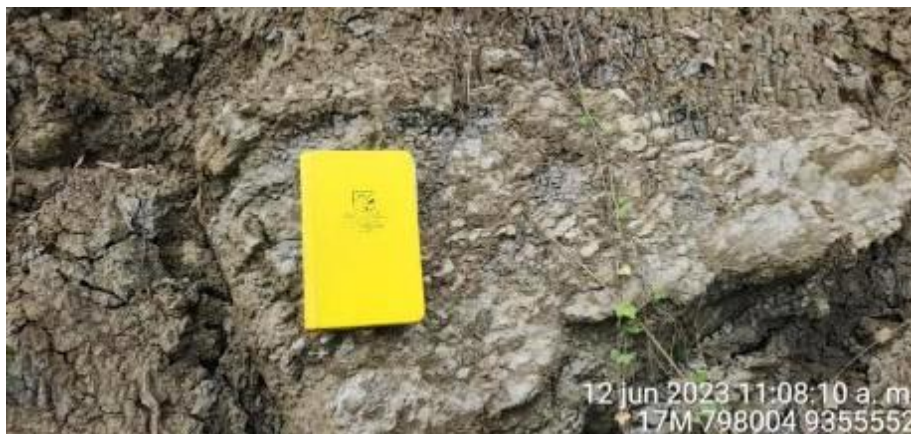
Fotografía 2. Suelos coluvio deluviales compuestos por suelos arcillo limosos de baja a mediana plasticidad ubicados en la localidad de Ñunya Temple.
