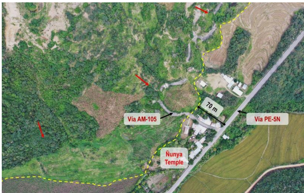
Figura 17. Vista del alcance actual del deslizamiento (delimitado en línea amarilla) junto al caserío Ñunya Temple y a 70 m de la vía nacional PE-5N.
