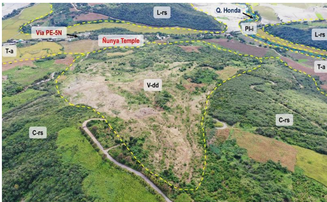
Figura 7. Geofomas cartografías en la localidad de Ñunya Temple: Colina en roca sedimentaria (C-rs), lomada en roca sedimentaria (L-rs), vertiente con depósito de deslizamiento (V-dd), terraza aluvial (T-a). planicie o llanura inundable (PI-i),
