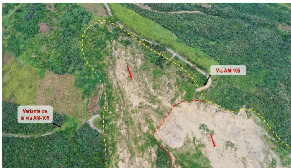
Figura 13. Parte alta del deslizamiento Ñunya Temple, se aprecia la vía AM-105 y su variante, ambas afectadas e intransitables; el cuerpo del deslizamiento está delimitado en amarillo y un escarpe secundario en rojo.
