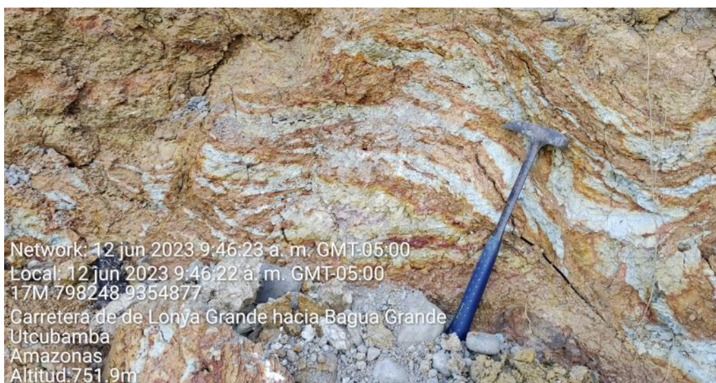
Fotografía 1. Muestra de lutitas y limolitas fragmentadas y altamente meteorizadas y de la Formación Celendín.
