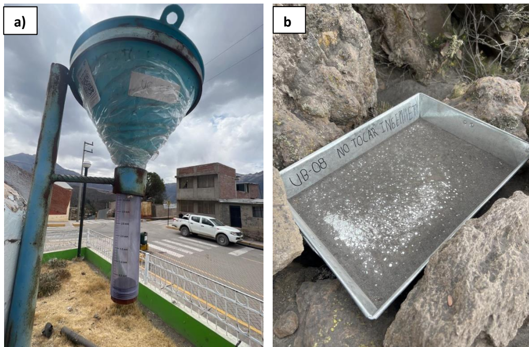
Figura 3. a) Muestreo de ceniza del cenizómetro UC-05, realizado el 05 de agosto en la estación de Anascapa alcanzó un espesor de 0.1 mm. b) La toma de muestra de ceniza de la bandeja UB-08 se realizó el 05 de agosto, se reportó un espesor de 1.3 mm de ceniza.
