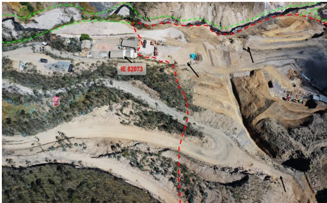
Figura 15. Vista de la parte baja del movimiento complejo La Victoria, el área afectada está delimitada en rojo, además se muestra el cauce del río Perejil (en verde) donde discurren constantes flujos de detritos.
