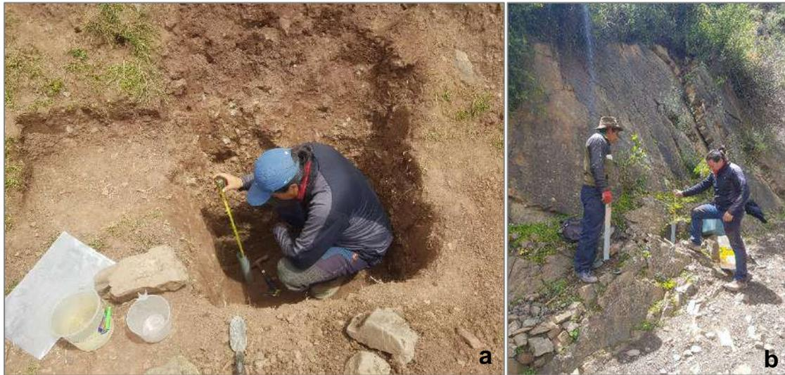
**Figura 13.** a) Ensayo de infiltración en suelo (CAL\_01). b) Ensayo de infiltración en arenisca cuarzosa (EI-18).
