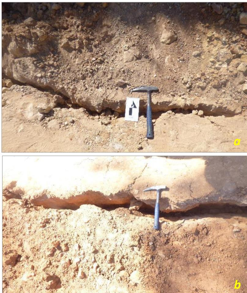
**Figura 10.** Escarpa del deslizamiento de aproximadamente 30 cm, en la ladera de Pariacancha.
