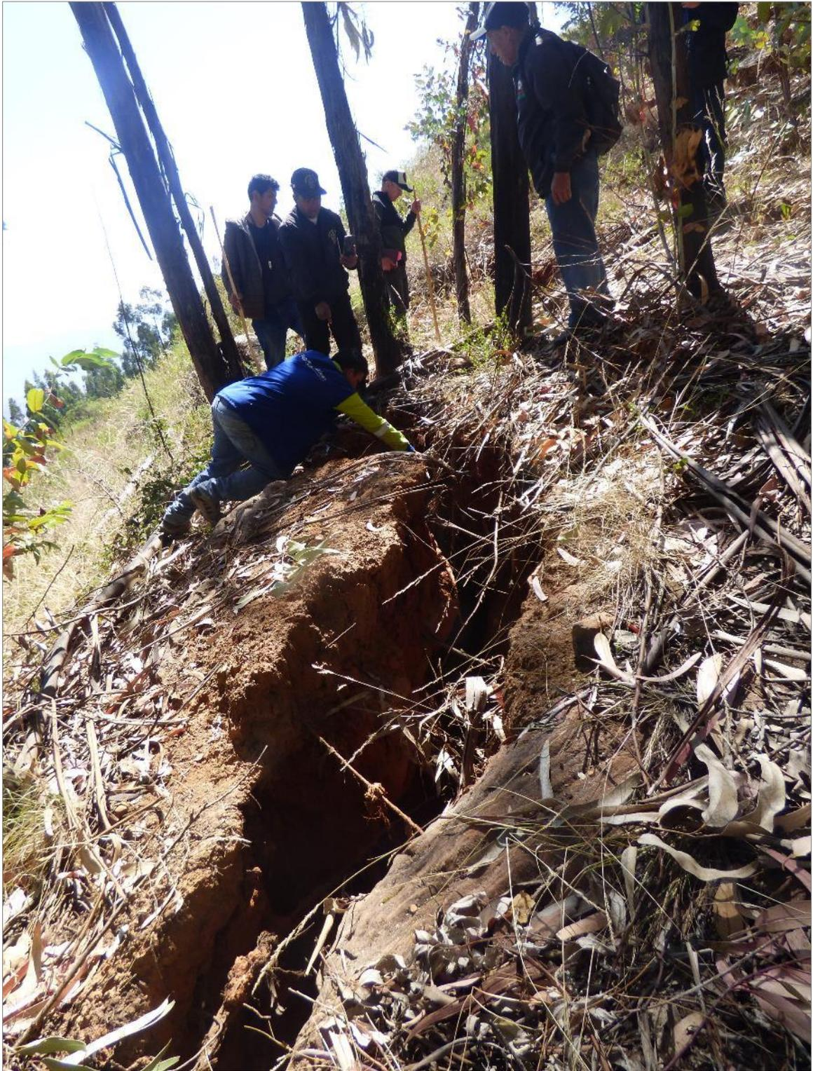
**Fotografía 2.** Vista de la corona del deslizamiento reactivado, con plano de falla rotacional y una profundidad de aproximadamente 10 m. Longitud calculada a partir de la longitud de un tronco de árbol.
