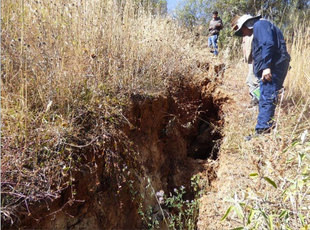
**Fotografía 5.** Vista del flanco derecho del deslizamiento reactivado, muestra un desplazamiento de hasta 5 m.
