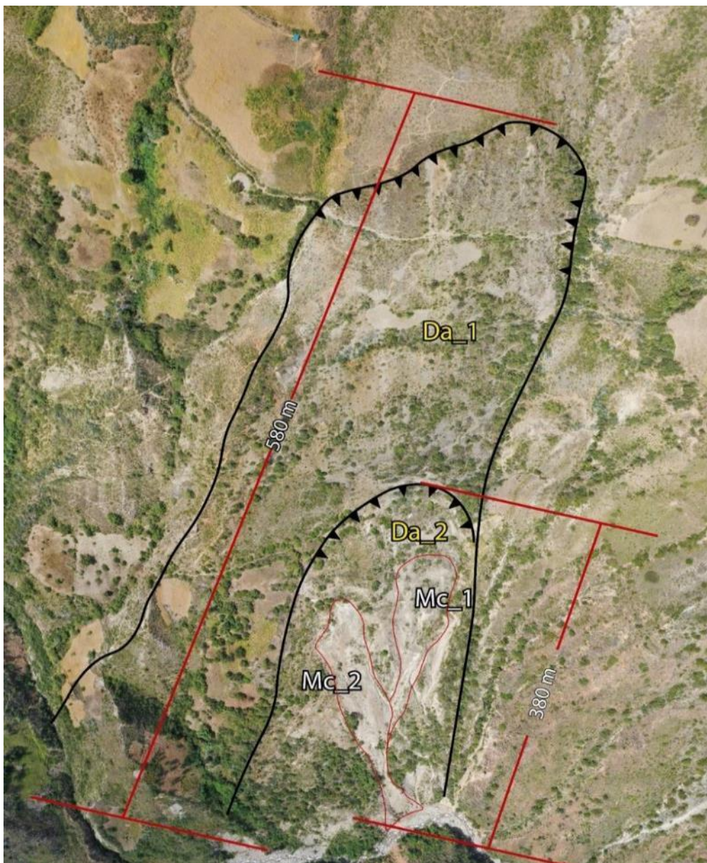
Figura 10. Muestra los deslizamientos activos Da_1 y Da_2, ubicados longitudinalmente a 465 m lineales del C.P Pueblo Libre y a una diferencia de alturas de 174 m entre el poblado y la corona principal.
