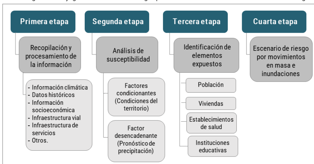
Figura 1. Flujoograma de la metodología para la elaboración de los escenarios de riesgo
