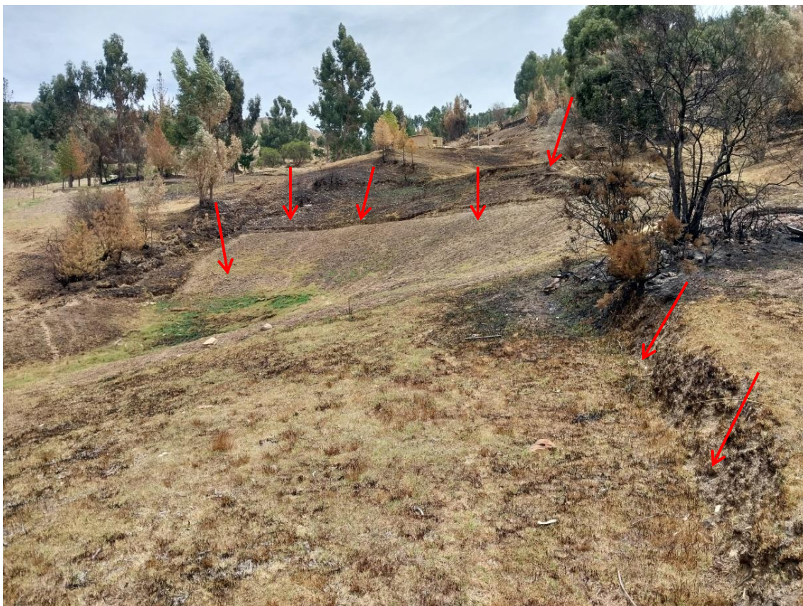
Foto 6 Deslizamiento activo sector "superior Callacunca" (UTM: 229640E/8469310N), se puede observar el asentamiento con escarpas que están produciendo la actividad geodinámica externa muy activa
