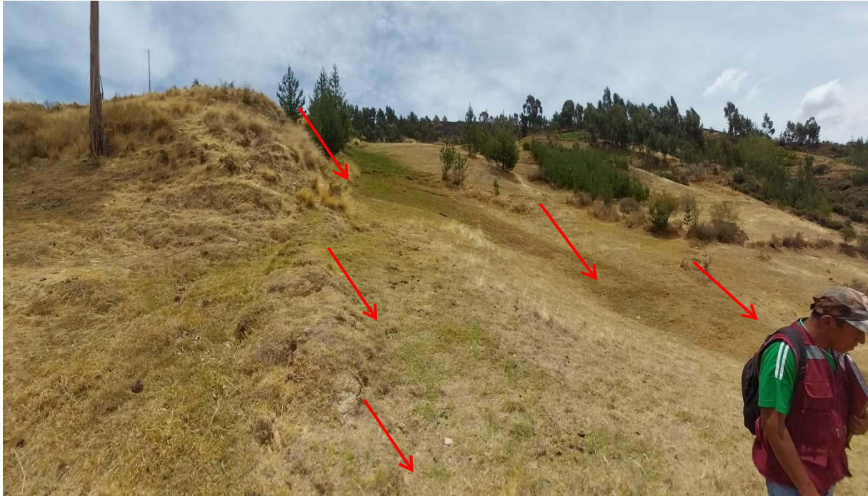
Cabecera de deslizamiento activo, se puede observar el contacto entre afloramiento de rocas y material que se viene deslizando
