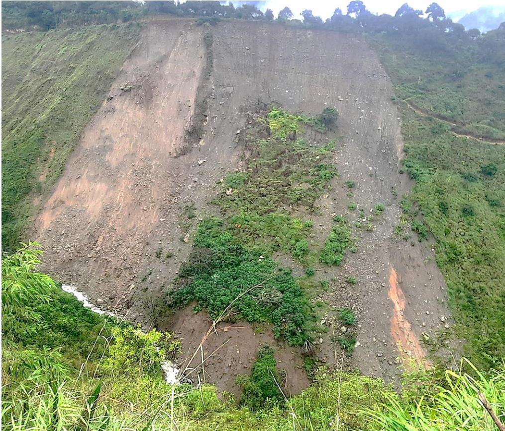
Foto 2. Vista frontal de depósitos coluvio deluviales, expuestos por la activación de deslizamientos en el sector Pacaybamba, Km 11+660 de la vía CU-100. En las coordenadas UTM 18 L E: 688436, S: 8530077
