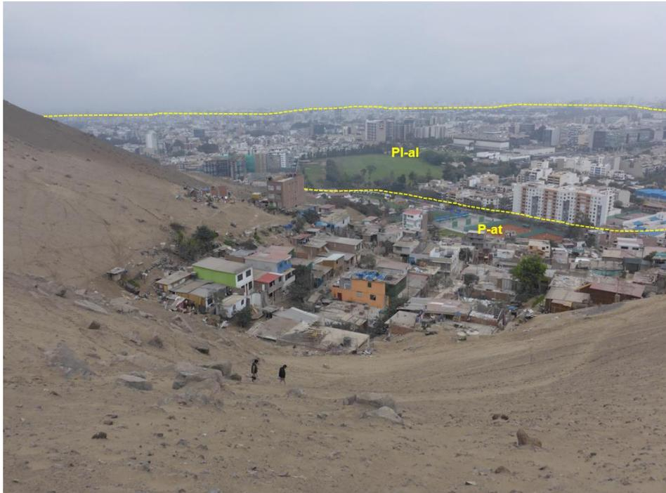
**Figura 5.** Geoformas de llanura o planicie aluvial y piedemonte aluvio-torrencial identificadas hacia el oeste del A.H. “Diente de Oro”.
