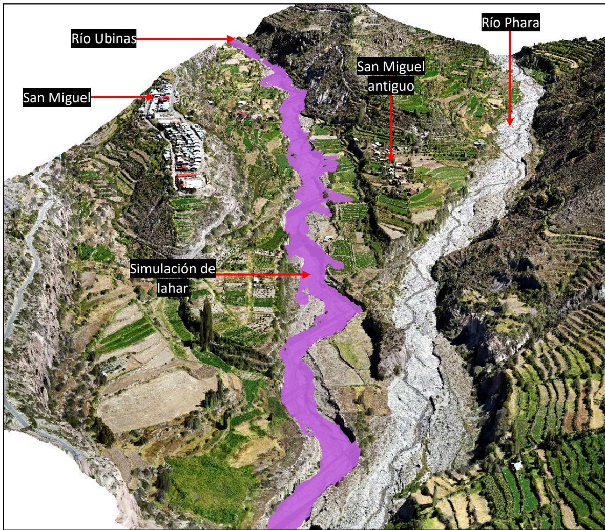
**Figura 20.** Vista ortométrica de la simulación de lahar (flujo de detritos) en el río Ubinas.
