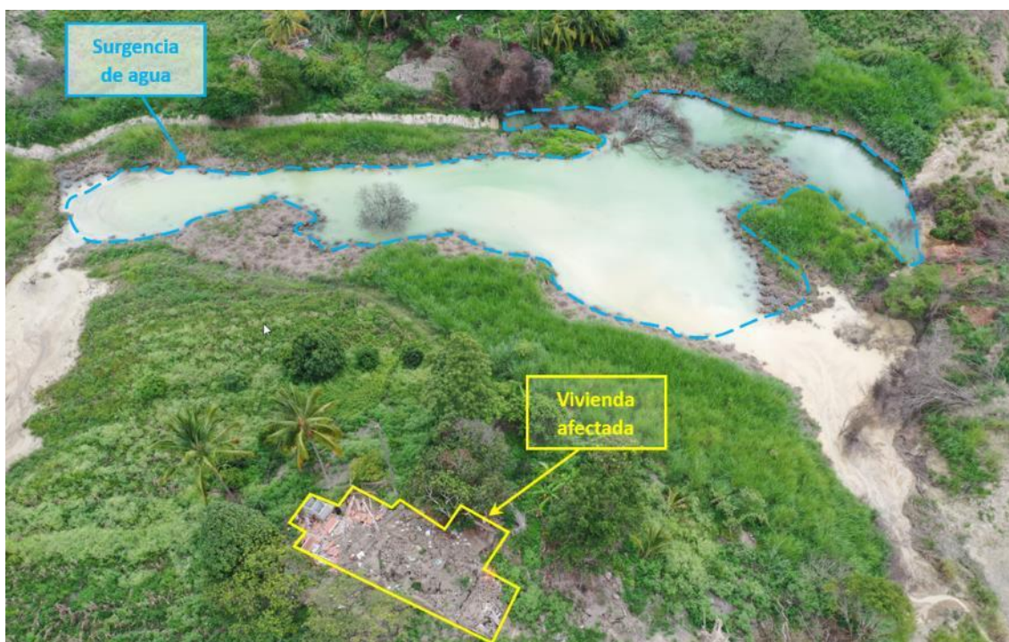
Figura 12. Vista de espejos de agua (línea celeste discontinua), en la parte media inferior, dentro del cuerpo del movimiento complejo, y vivienda afectada (línea amarilla continua). Coordenadas: E: 806427, N: 9357227.
