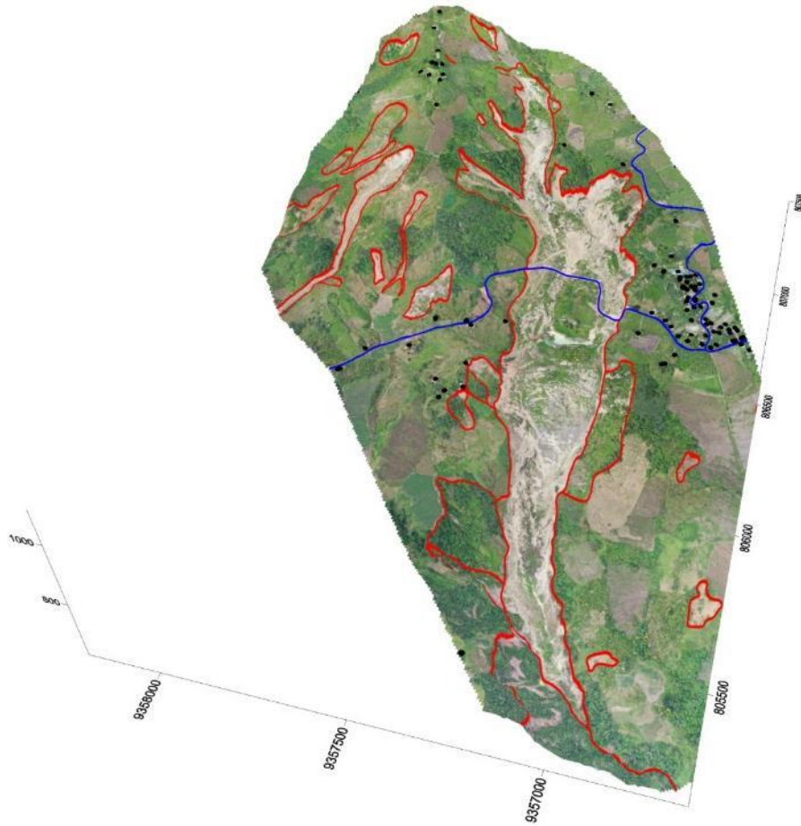
Figura 4. Modelo 3D de imagen aérea de la localidad El Triunfo; los movimientos activos están delimitados en línea roja, la vía vecinal afirmada representada en línea azul, las viviendas con puntos azul oscuro.
