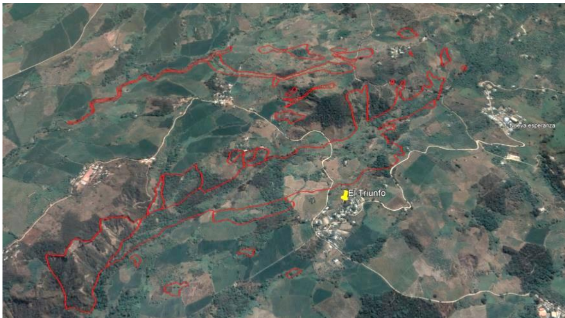
Figura 15. Los sectores afectados por movimientos en masa (polígonos en líneas rojas), estaban ocupados por cultivos agrícolas con riego por inundación y con agua permanente como el cultivo de arroz, factor detonante del movimiento.
