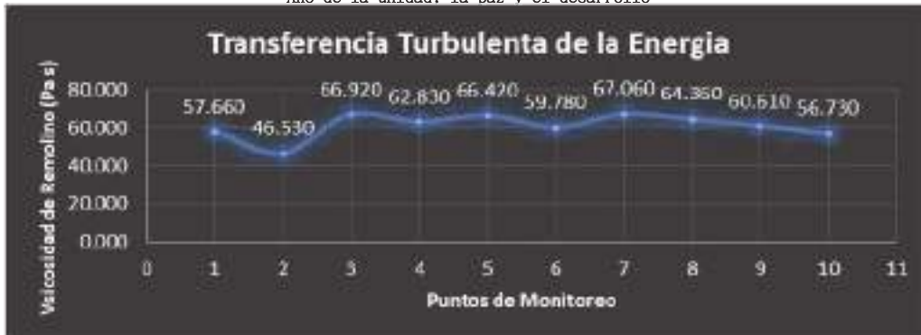
Figura 17.0. Determinación de la transferencia turbulenta de la energía sobre los puntos de monitoreo para la determinación del potencial erosivo hidráulico de la corriente. Fuente: Elaboración Propia
