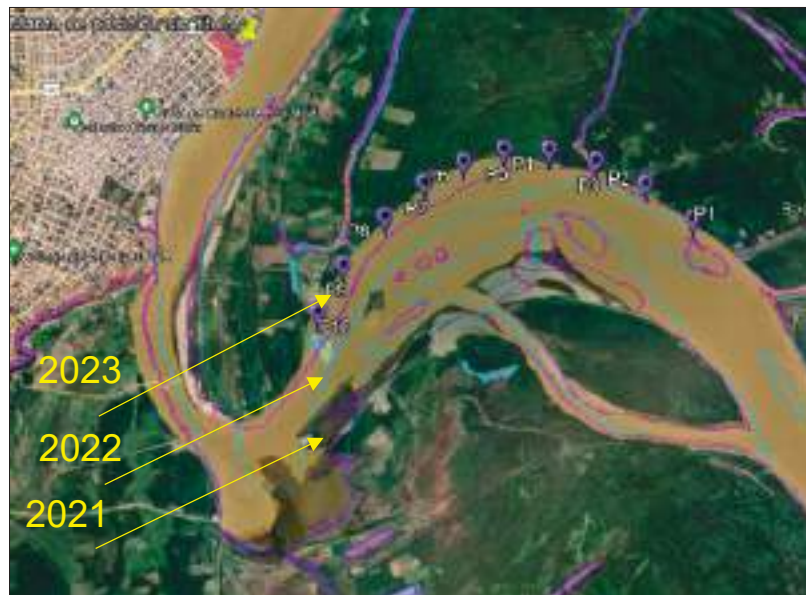
Figura 18. Las imágenes de las riberas se han extraído de tres (03) imágenes satelitales PeruSat-1 correspondientes al 24-08-2021, 23-08-2022 y 09-09-2023, proporcionadas por CONIDA, las cuales en sus bandas multiespectrales alcanzan una resolución de 1 metro, determinan que, la tasa de erosión y avulsión hidráulica lateral para el sector P5-P10 es mayor que el sector P1-P5 Fuente: CONIDA.
