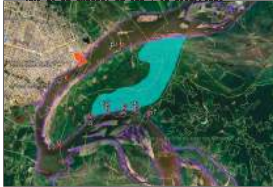
Figura 31. Zona de mayor probabilidad de rompimiento del meandro. Fuente: Elaboración propia.
