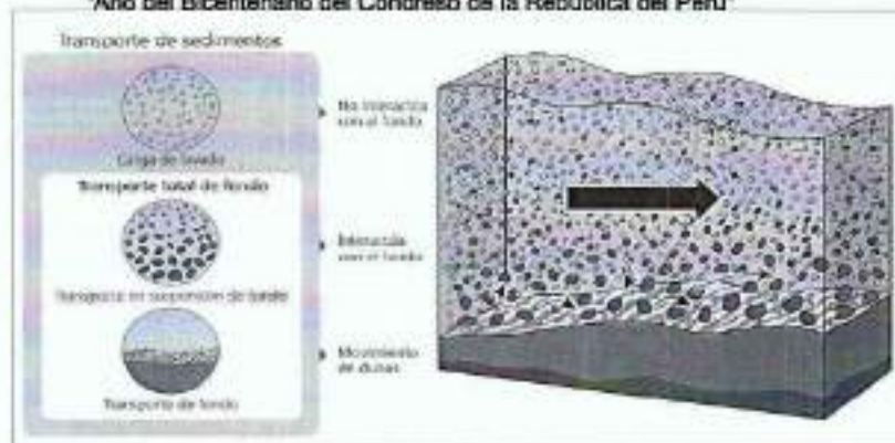
Figura 1.0. Tipos de sedimentos transportados por el río Ucayali Fuente: UTEC 2017 /2019
