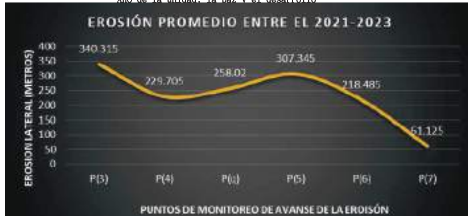
Figura 24.0. Erosión lateral promedio determinado para el periodo 2021- al 2023 Fuente: Elaboración Propia
