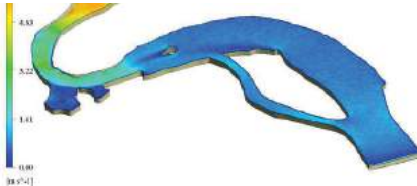
Figura 12.0. Volumen de control y modelamiento computacional del meandro Pucallpa - Parahuasha
