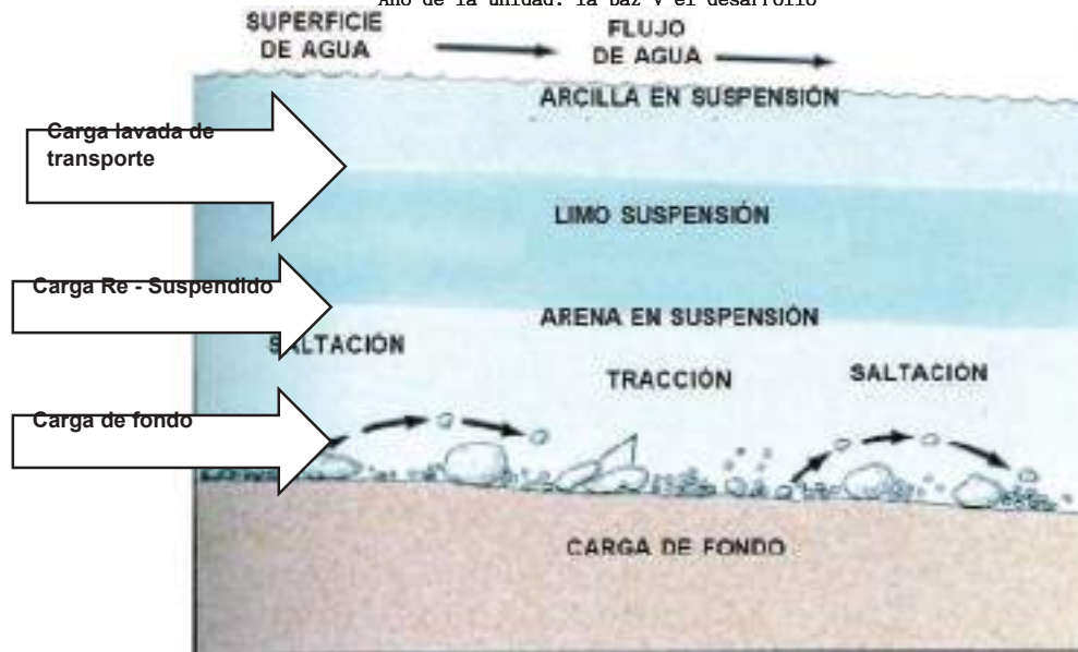
Figura 21. Transporte de Sedimentos, estratificación de sólidos. Fuente: UTEC 2017 /2019
