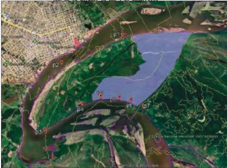
Figura 25. Topografía estimada del meandro Pucallpa -Parahuasha, análisis de zonas de mínimo nivel que facilitarían la erosión del río.
