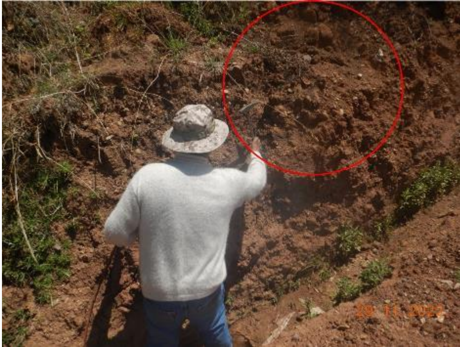
Figura 3. Se aprecia el depósito aluvial, compuestas por gravas sub angulosas a sub redondeadas con matriz de arena, limo y arcilla.
