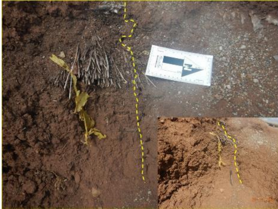
Figura 9. Se puede ver una grieta en un corte del suelo con apertura de 1 cm.
