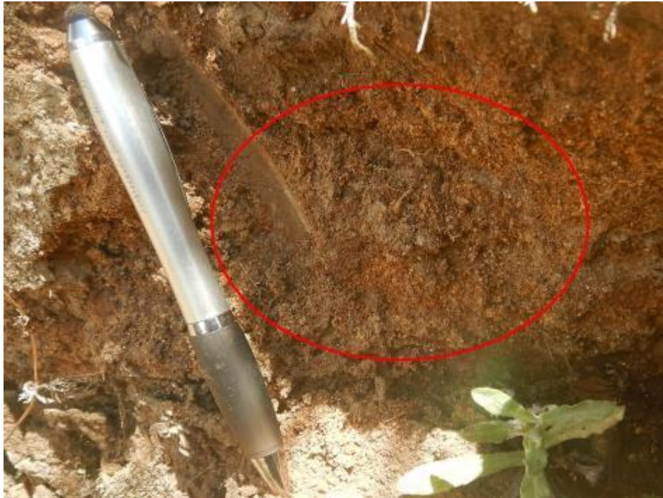
Figura 2. Se aprecia la cuarzdiorita granular con minerales visibles y completamente meteorizada.
