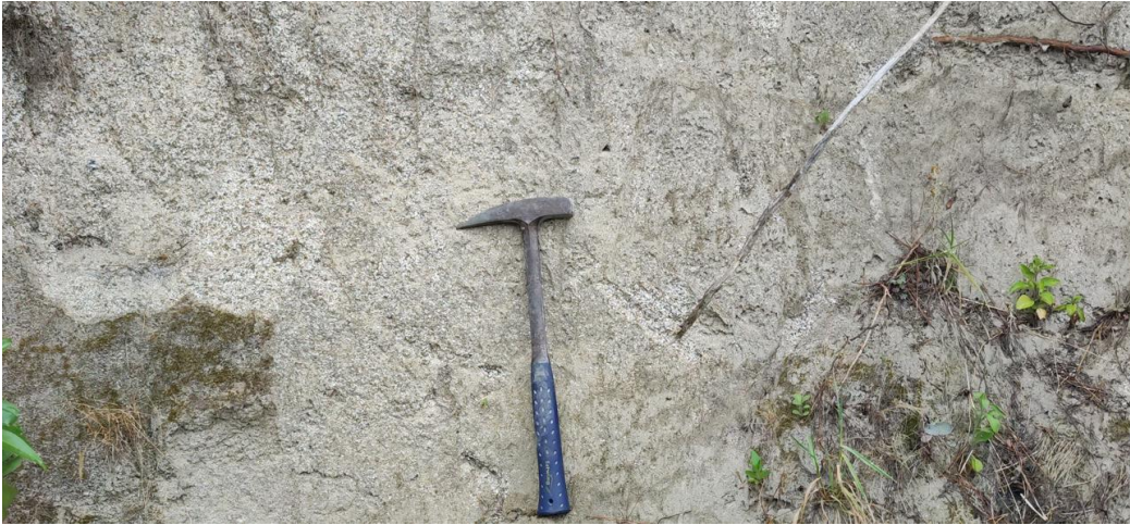
Fotografía 16. Macizo rocoso granodiorítico poco fracturado y altamente meteorizado en la localidad de Huayabamba. Coordenadas E: 677038; N: 9330558 (12/09/2023).
