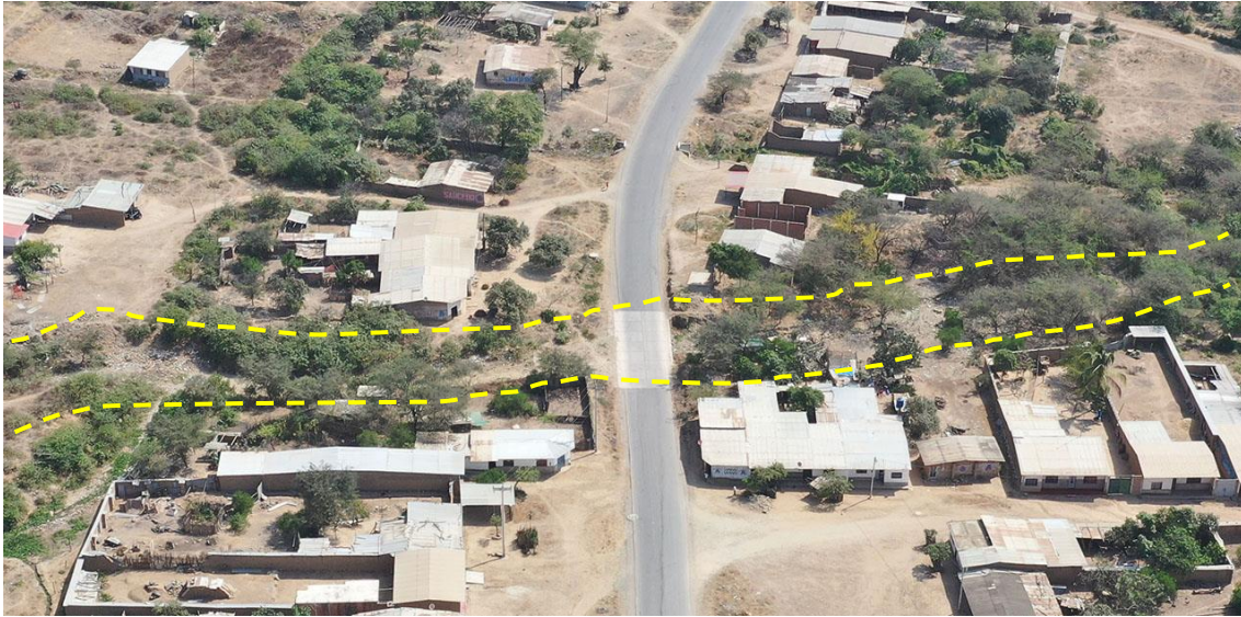
Fotografía 141. Zona crítica 14-110, flujo de detritos en la localidad de Desaguadero que podría afectar 1 badén de la vía LA-103 y 3 viviendas. Coordenadas E: 655945; N:9288818. (13/09/23).
