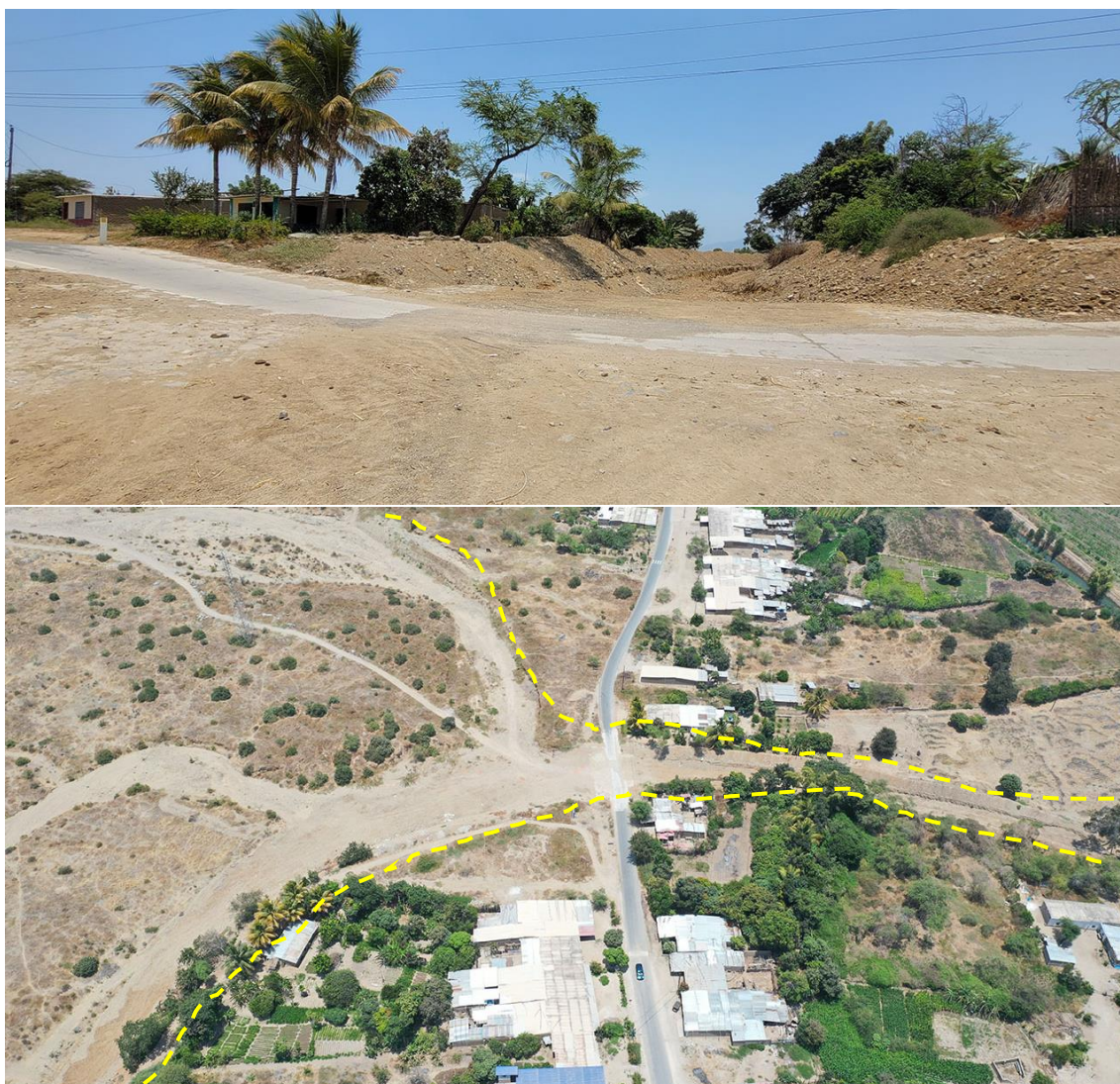
Fotografía 33. Zona crítica 14-002, flujo de detritos en la localidad de Pampa Grande que podría afectar 3 viviendas, 1 badén de la vía LA-116 y 20 m de un canal de regadío. Coordenadas E: 667583; N:9252707. (28/09/23).
