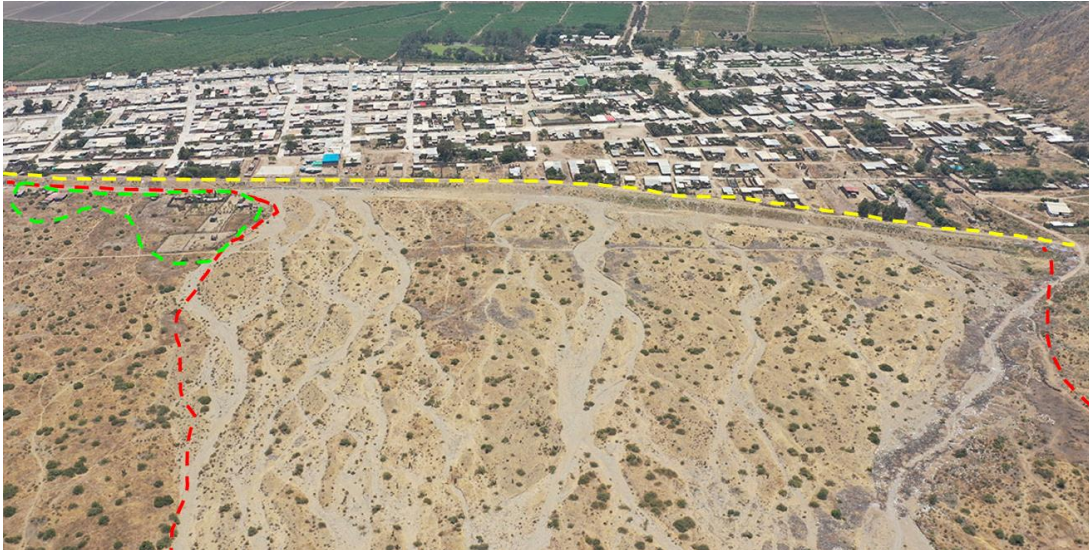
Figura 25. Flujos de detritos en la localidad de Pampa Grande, Chongoyape (ZC 14-003), donde se aprecia la gran amplitud de los lujos (en rojo) además de una terraplén de contención (en amarillo), sin embargo, también se distinguen viviendas instaladas en el lado crítico.
