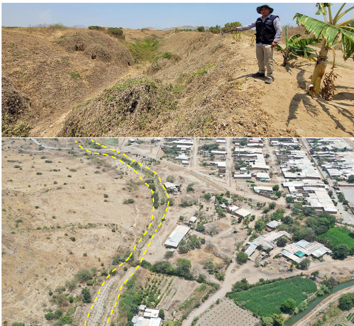
Fotografía 124. Zona crítica 14-093, flujo de detritos en la localidad de Pachерres que podría afectar 50 viviendas de la localidad ante colapso del canal de coronación. Coordenadas E: 663229; N:9250227. (26/09/23).
