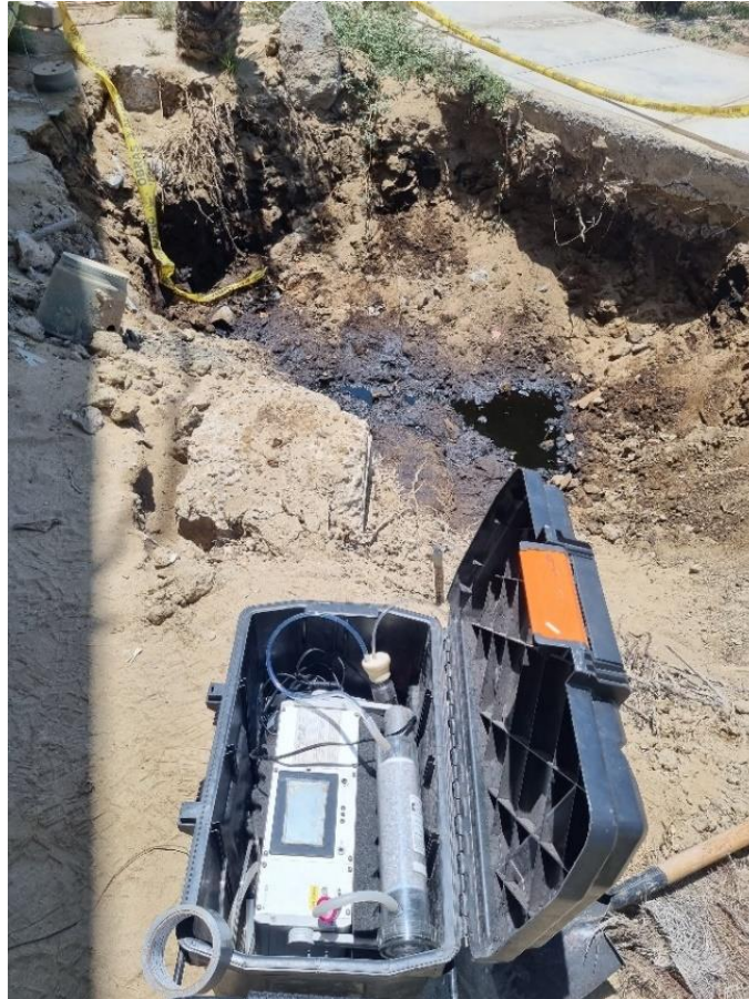
Foto 1. Sistema de medición continua de radón en el aire del suelo (Monitor RTM 2200)
