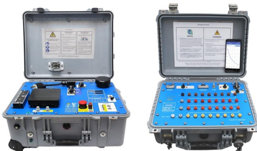
Figura 6. a) Equipo receptor GRx8-32; b) Equipo transmisor GDD TxII 5000 W.
