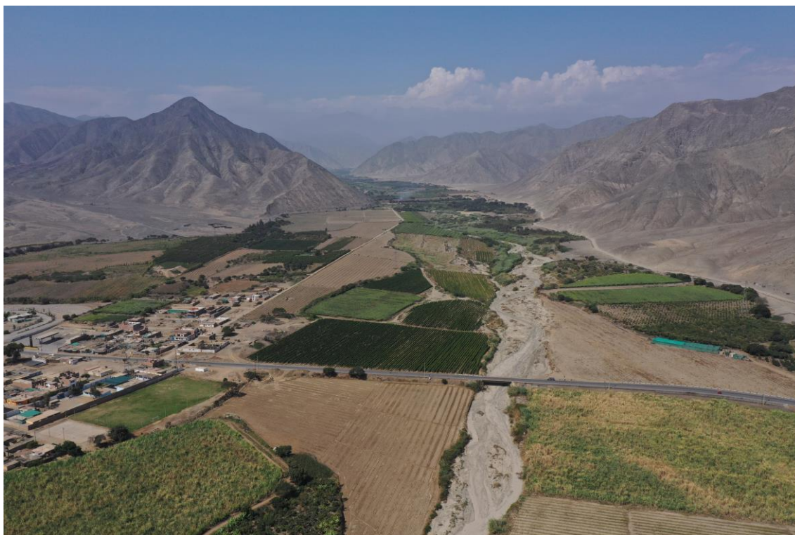
Fotografía 304. La imagen capturada con dron, se observa el centro poblado Tunan ubicado en la quebrada Julquilla, con el periodo de lluvias intensas y/o prolongadas se generan flujos de detritos que podrían ocasionar daños a los terrenos de cultivo, infraestructura y viviendas. Coordenadas UTM, corresponden a 8830370 al norte y 198204 al este.
