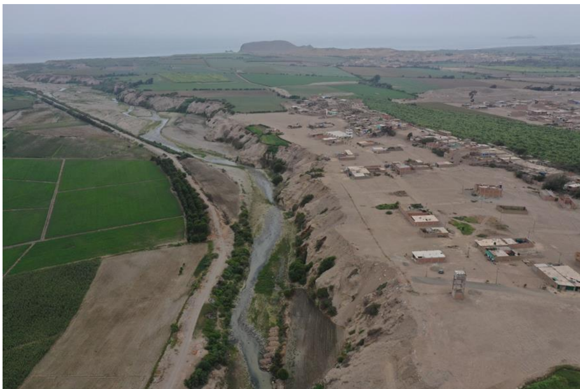
Fotografía 335. La vista tomada con un dron nos muestra una imagen del río Huaura y el sector Santa Ana, propenso a experimentar procesos geológicos como erosión fluvial, derrumbes y deslizamientos, afectaría viviendas asentadas cerca al cauce del río. Las coordenadas UTM correspondientes son 8774773 al norte y 217437 al este.
