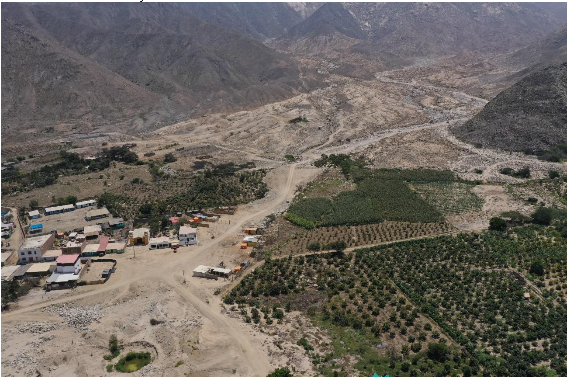
Fotografía 301. En la imagen tomado con Drone se observa el centro poblado de Huáncar se ubica en la desembocadura de una quebrada donde se generan flujos en periodo de lluvias intensas. Coordenadas UTM 8852600 norte -y: 207000 este.
