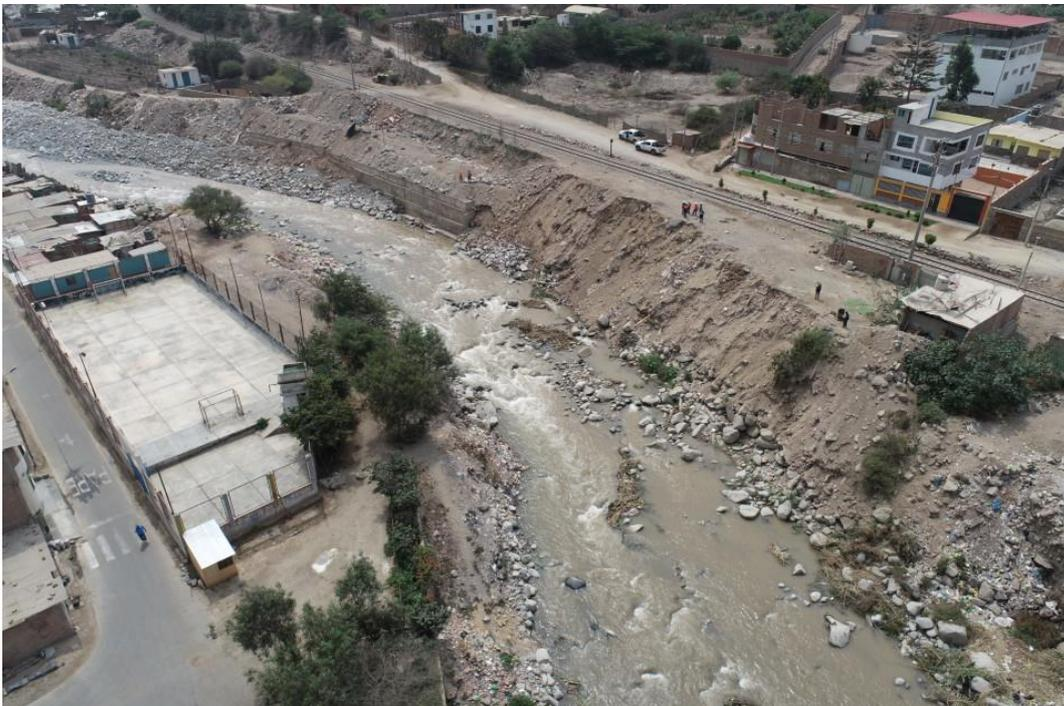
**Fotografía 159.** Zona crítica 15-048. Erosión fluvial en margen izquierda del río Rímac, viviendas del sector Cooperativa Pablo Patrón se encuentran asentadas sobre depósitos de relleno. Coordenadas UTM 18S E316629; N8681042 (tomada el 06/10/2023).
