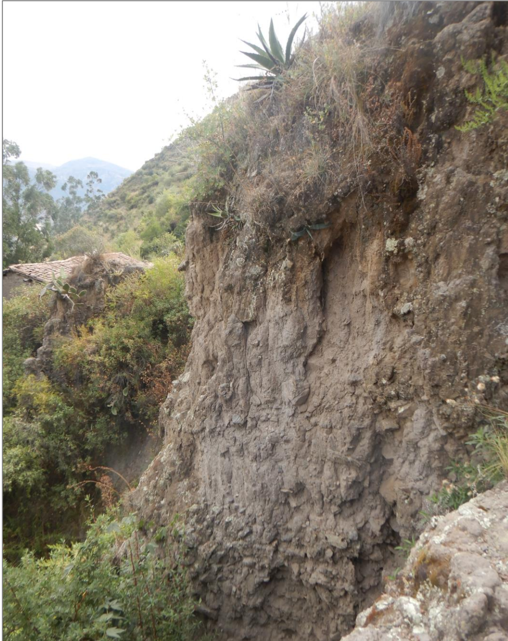
Fotografía 1. Depósito coluvio- deluvial, compuesto por bloques de formas angulosas a subangulosos con diámetros de hasta 60 cm, envueltos en una matriz de areno – limoso color gris oscuro, con poco contenido de arcilla.
