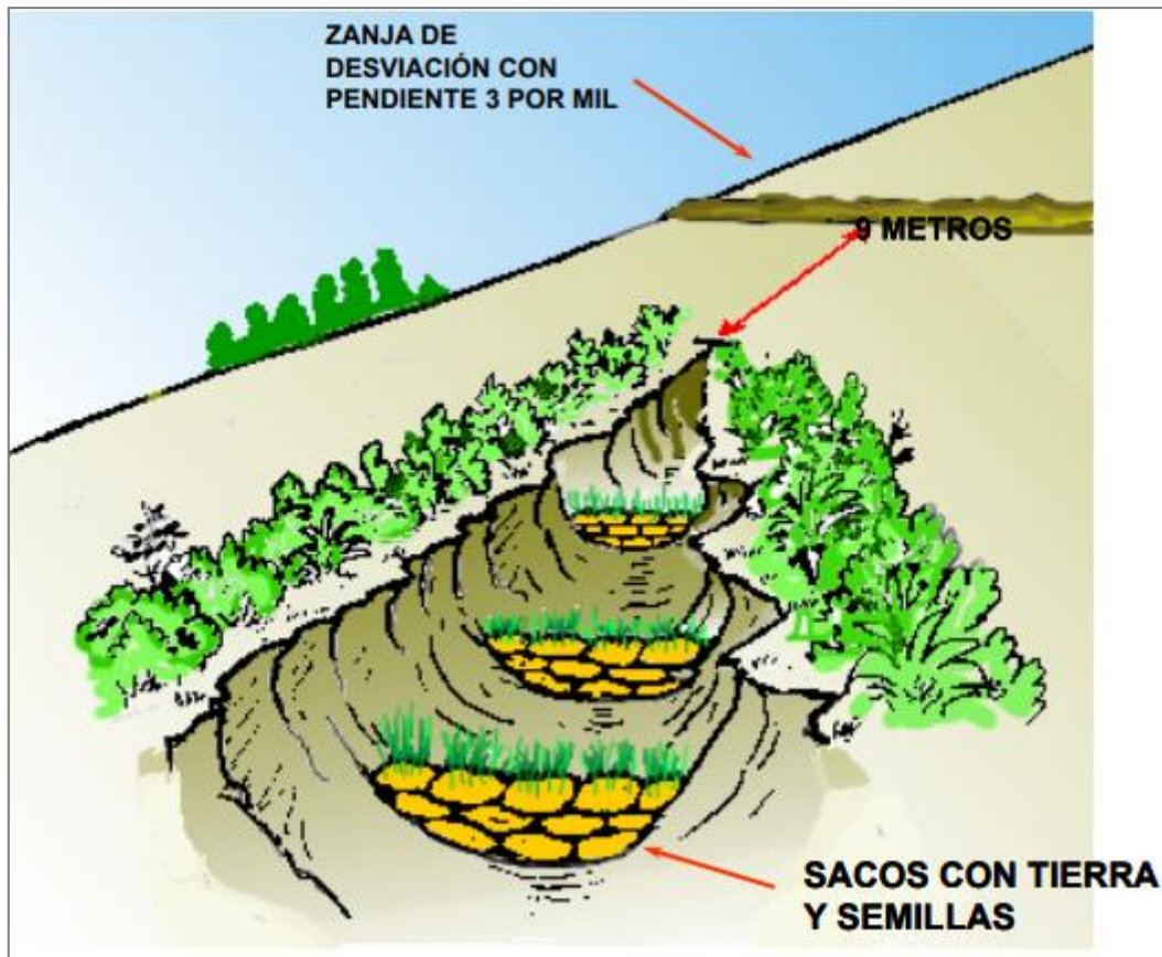
Figura 6. Ilustra medida de mitigación para reducir el avance retrogresivo de las cárcavas con plantaciones nativas, además, incluye la colocación de saco con abono y semilla de plantaciones, para reducir y/o atenuar la energía y material proveniente de desde la parte alta en forma de flujo de detritos. Fuente: Carrasco, J.
