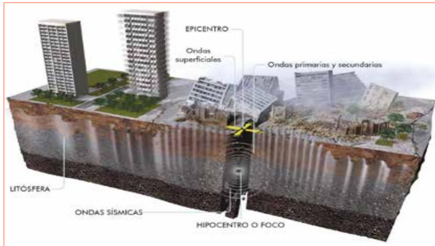
IMAGEN 2—24 : Efectos de ondas sísmicas en edificaciones
