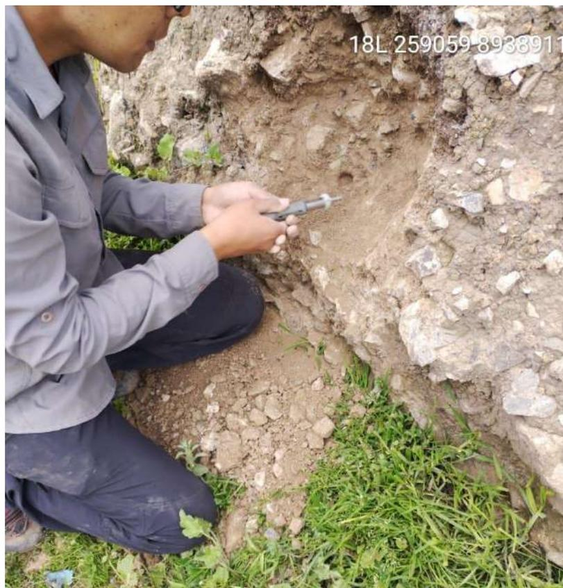
*Fotografía. 2. Prueba de penetración de suelo para toma de muestras a cargo del geólogo del equipo técnico.*
