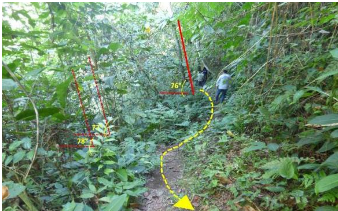
Figura 10. La imagen muestra inclinación de árboles en otro punto ladera arriba de la montaña, en la margen derecha del río Tulumayo, con ángulos de inclinación a favor de la pendiente de 76°-78° esto indicaría un proceso geodinámico lento de movimiento del suelo. En flechas amarillas punteadas se observa el sendero que se siguió como ruta.
