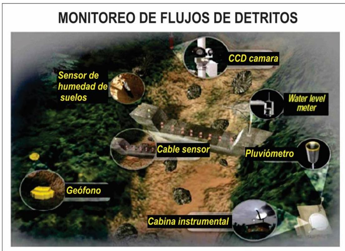
Figura 6. Sensores utilizados para el monitoreo de flujos de detritos (fotografía tomada de Soil and Water Conservation Bureau SWCB-Taiwan por Vílchez, 2010).
