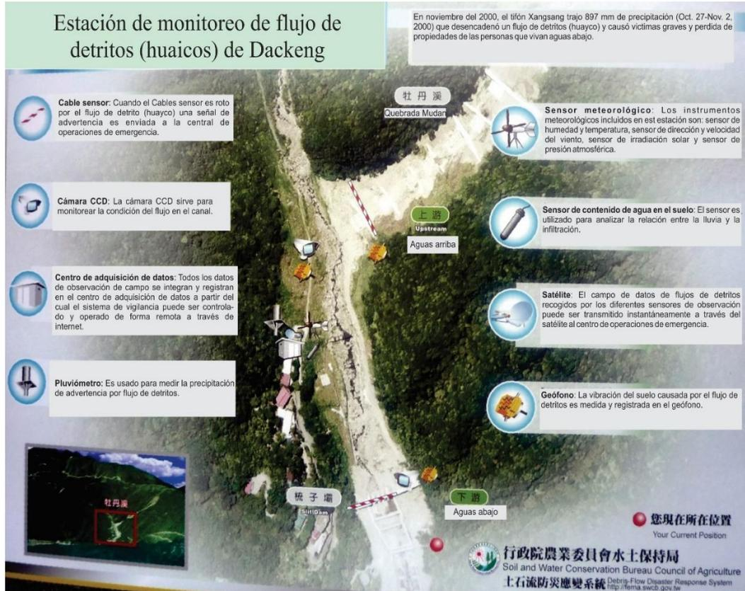
**Figura 7.** Estación de monitoreo de flujo de detritos (fotografía tomada de Soil and Water Conservation Bureau SWCB-Taiwan por Vilchez, 2010).
