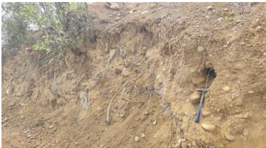
Fotografía 3. Suelos coluvio deluviales recientes, con bloques y cantos sub redondeados en una matriz de arcillas y limos de alta plasticidad.
