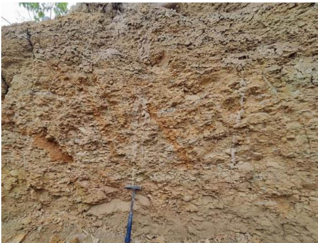
Fotografía 1. Vista de estratos sub verticales de areniscas cuarzosas de la Formación Chimú al norte del área evaluada. Coordenadas, E: 782912 y N: 9361976.
