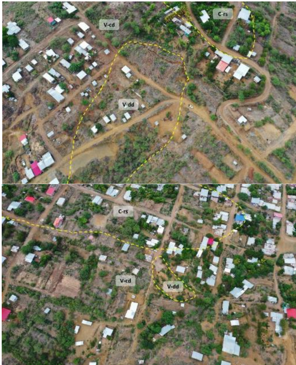
Figura 7. Geformas cartografías en los sectores de San Luis Alto (arriba) y Los Libertadores (abajo) donde se distingue colina en roca sedimentaria (C-rs), vertiente coluvio deluvial (V-cd) y vertiente con depósito de deslizamiento (V-dd)
