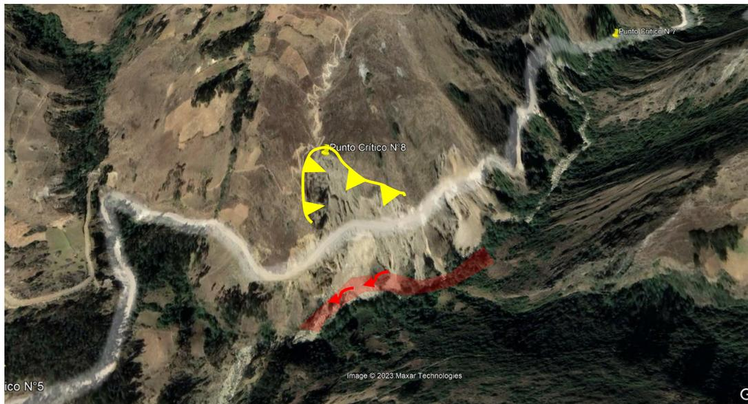
**Imagen N° 14.** Deslizamiento sobre la vía vecinal y socavación del río al margen derecho de la quebrada Chogo vista en Planta.
