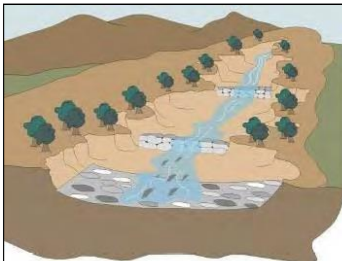
Figura 9. Presas transversales a cursos de quebradas y crecimiento de bosques Ribereños, (Vilchez, 2021)
