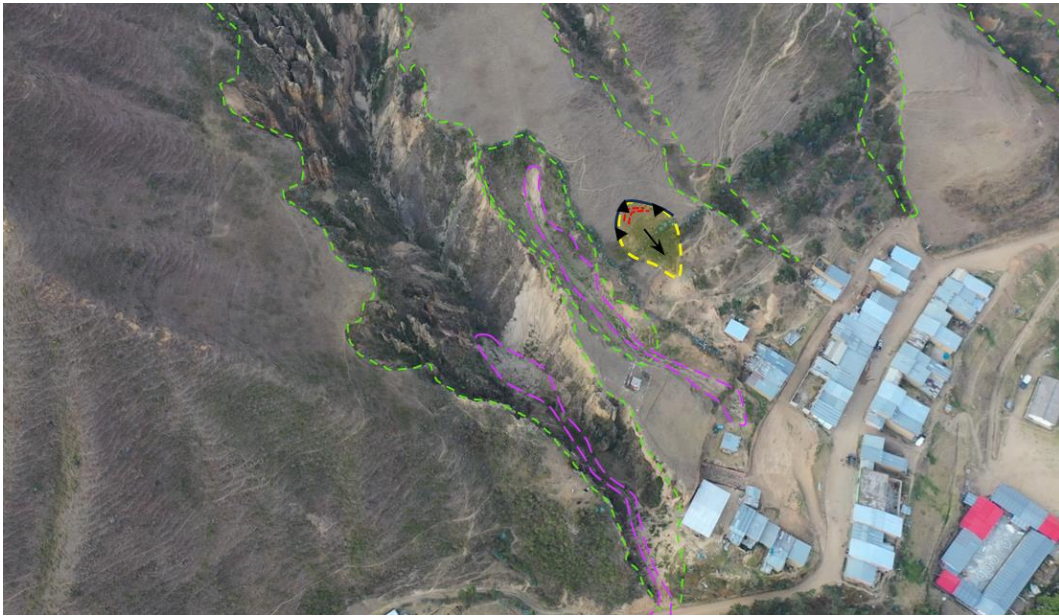
Figura 7. Movimientos en masa tipo erosión de laderas (líneas discontinuas verdes), flujo de lodos (línea discontinua fucsia) y deslizamiento rotacional (línea discontinua amarilla).
