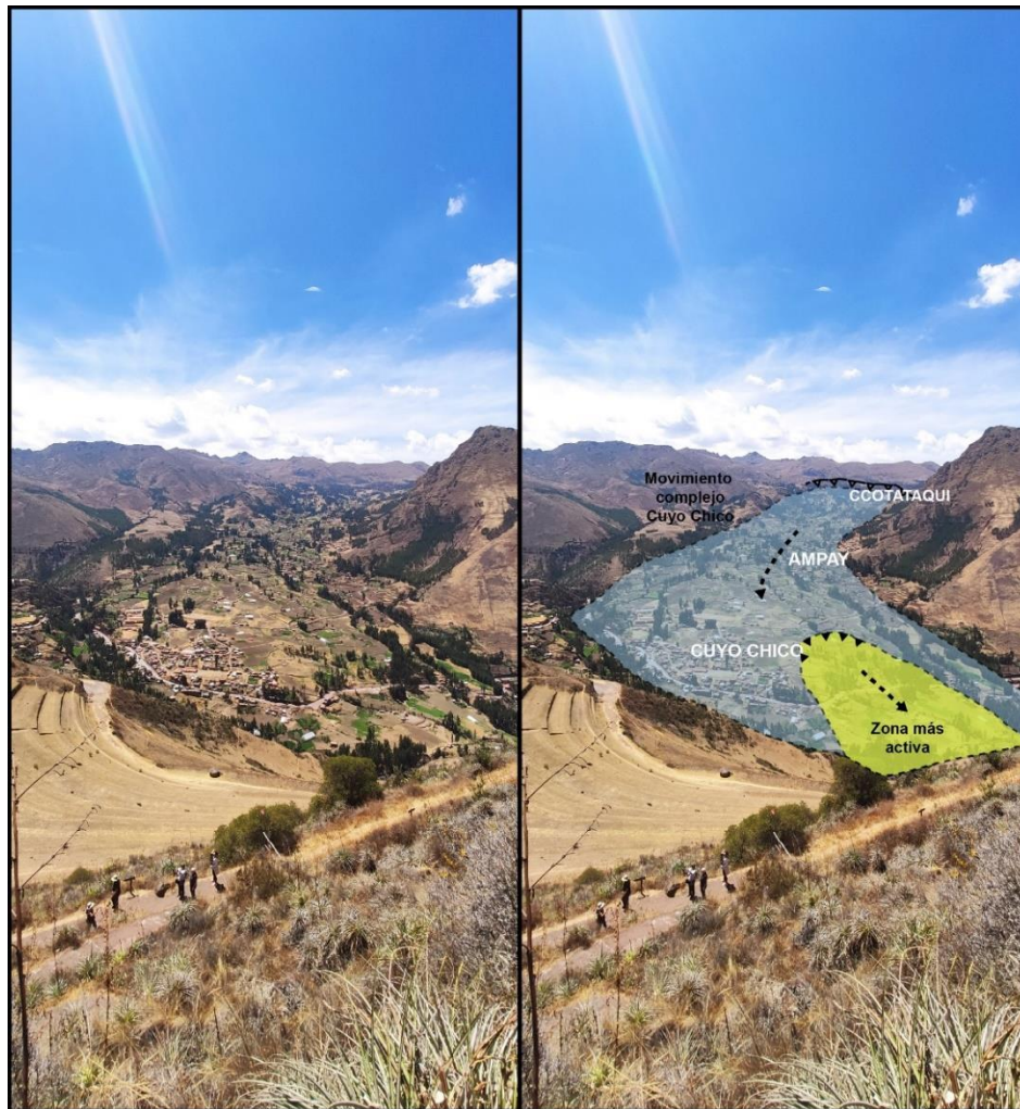
Figura 3. Interpretación general del mega deslizamiento de Cuyo Chico. Se observa el límite inferido del evento antiguo con origen en la parte alta (Ccotataqui). El polígono de color amarillo delimita de forma estimada la zona que actualmente presenta mayor actividad.
