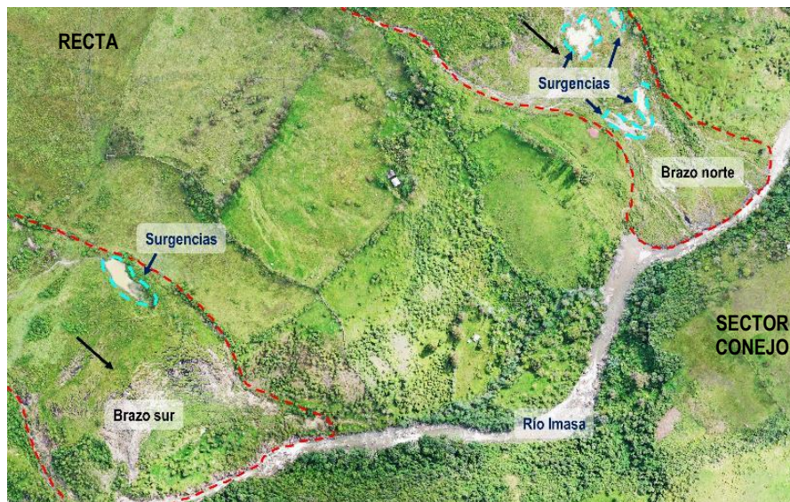
Figura 10. Vista a la parte baja del movimiento complejo, donde los materiales se han comportado como flujos que han alcanzado al cauce del río Imasa.
