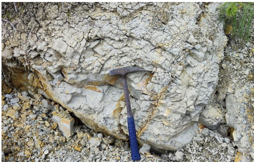
Fotografía 1. Muestra de calizas muy fracturadas y de la Formación Chonta. Ubicación: E: 191736, N: 9346744, Z: 2006.
