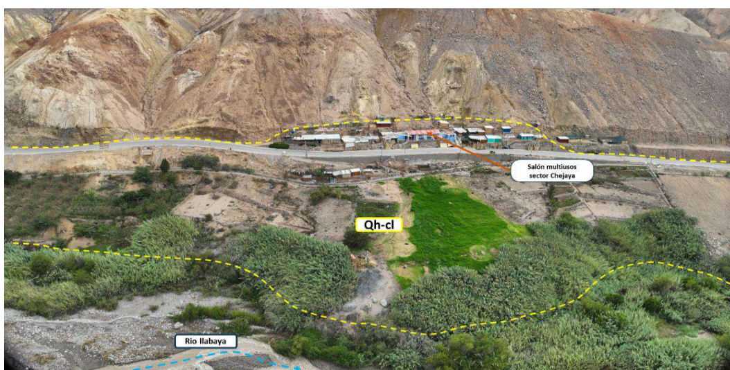
Fotografía 31 Identificación de depósitos coluviales (Qh-cl) al pie del corte de talud de la carretera en el sector de Chejaya.
