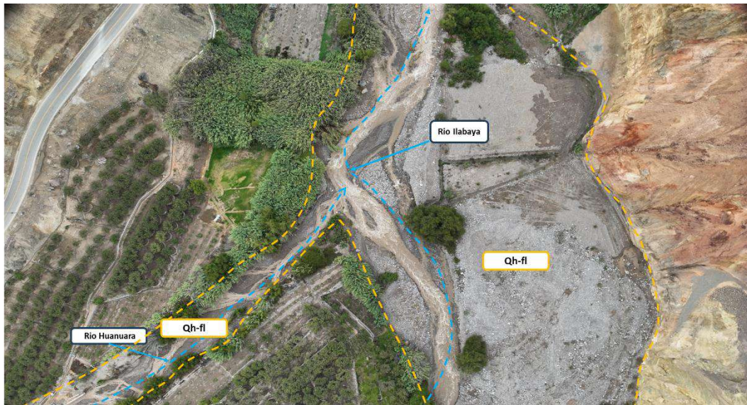
Fotografía 27 Identificación de depósitos fluviales (Qh-fl) en el cauce del Rio Ilabaya y en el cauce del rio Huanuara.
