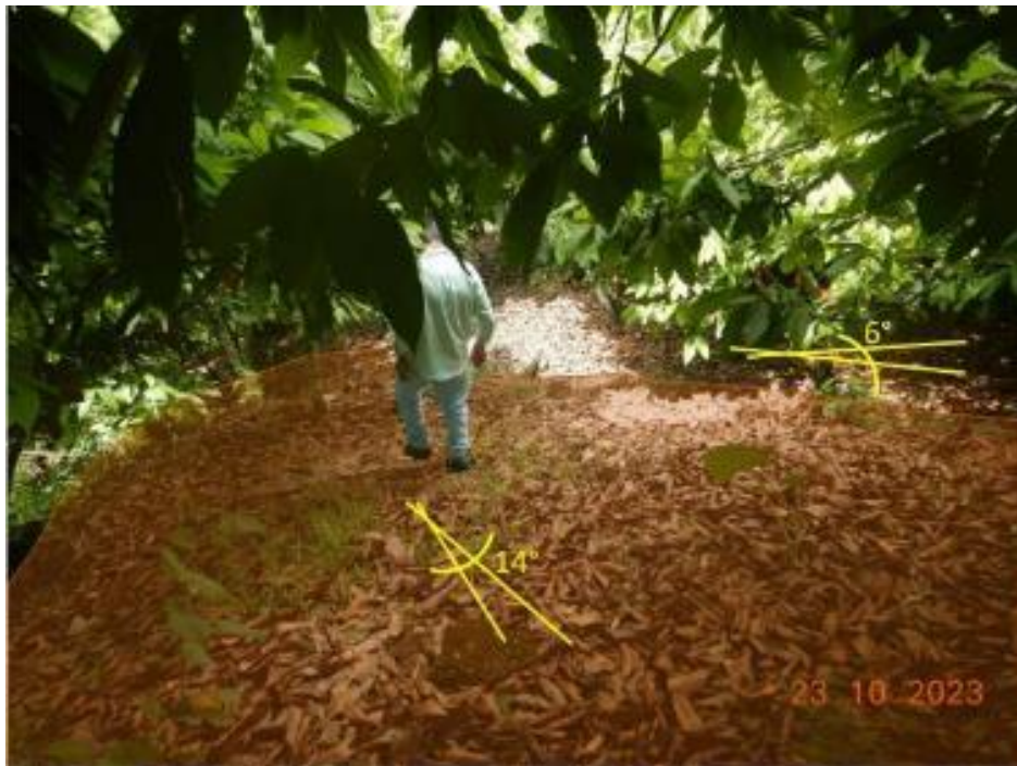
Figura 16. Se aprecia un cambio de pendiente en el pie del deslizamiento, en el punto de reubicación.
