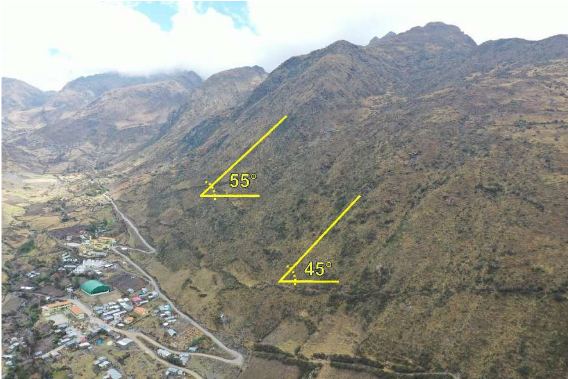
Figura 7. Vista de la inclinación de las laderas colindantes al poblado de Sune Grade, donde se muestra pendientes muy fuerte a muy escarpadas ( 25^\circ - >45^\circ ).
