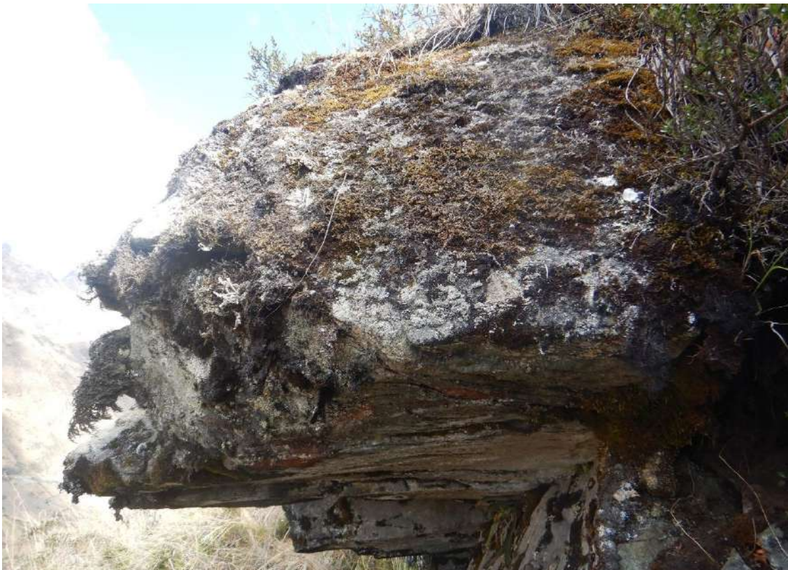
Fotografía 2. Vista a detalle de los esquistos, donde es posible apreciar las discontinuidades por esquistosidad y su pronunciado fracturamiento. Coordenadas referenciales UTM WGS-84, 18S: E: 544159.7; N: 8648462.4.
