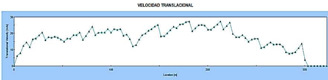
Gráfico 1. Se muestra la velocidad de caída a lo largo del perfil CC' con valores máximos de hasta 27.3 m/s y mínimos de 0.1 m/s.
