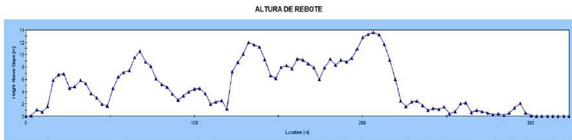
Gráfico 2. Se muestra la altura de rebote a lo largo del perfil CC' con valores máximos de hasta 13.5 m y mínimos de 0.2 m.
