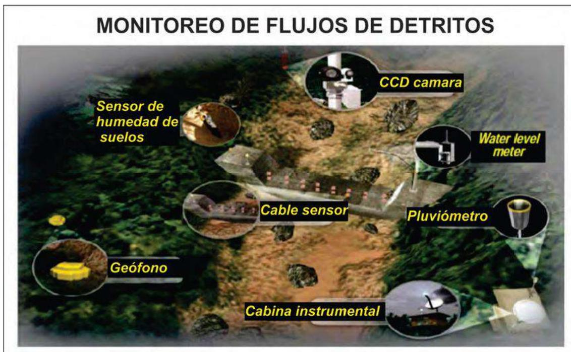
**Figura 6.** Sensores utilizados para el monitoreo de flujos de detritos (fotografía tomada en el Soil and Water Conservation
