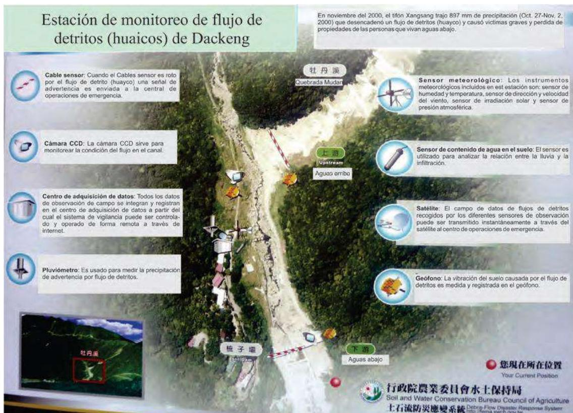
Figura 7. Estación de monitoreo de flujo de detritos (fotografía tomada de Soil and Water Conservation Bureau SWCB-Taiwan. por Vilchez, 2010).
