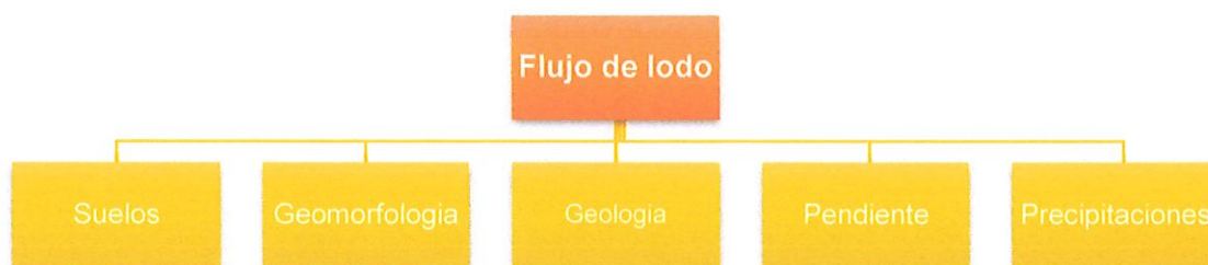
Figura N° 18. Esquema de variables para determinar el peligro por flujos de lodo en el distrito Corrales
