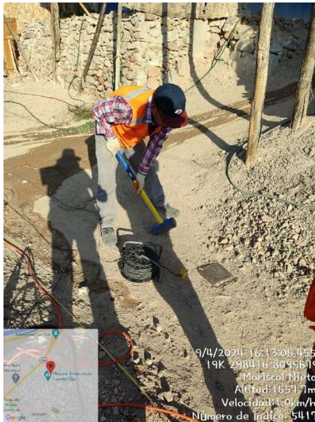
FOTO 29: Vista de los trabajos de refracción sísmica mediante golpes con comba, ejecutados por parte del equipo técnico.
