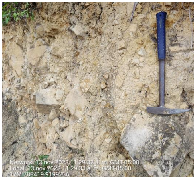
Fotografía 1. Suelos coluvio deluviales en lento movimiento, compuestos por bloques en una matriz de arenas y limos.
