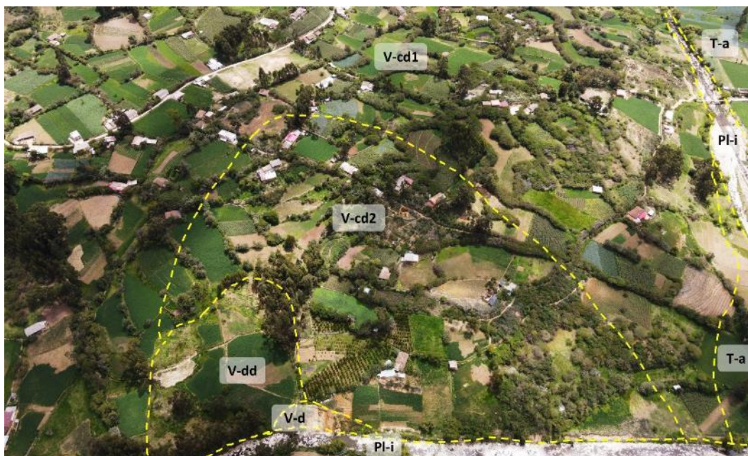
Figura 6. Geformas cartografías en la localidad de La Succha: Vertiente coluvio deluvial 1 y 2 (V-cd1 y V-cd2), vertiente con depósito de deslizamiento (V-dd), vertiente coluvial de detritos (V-d), terraza aluvial (T-a) y planicie inundable (PI-i).
