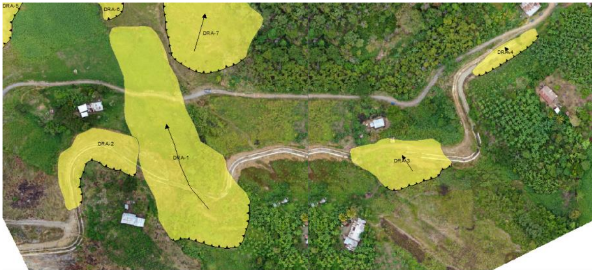
Figura 14. Deslizamientos activos en las proximidades del centro poblado Potrerillo.
