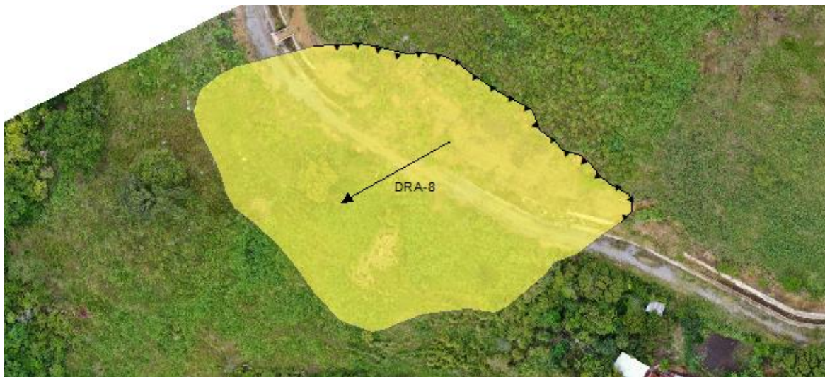
Figura 16. Deslizamientos activos en las proximidades del centro poblado Potrerillo.
