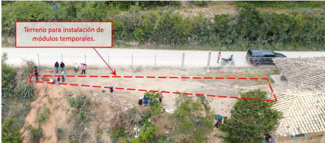
Figura 7. Se observa el terreno inclinado con pendiente suave ( 1^\circ - 5^\circ ), (líneas rojas discontinuas), apto para la instalación de aulas prefabricadas.
