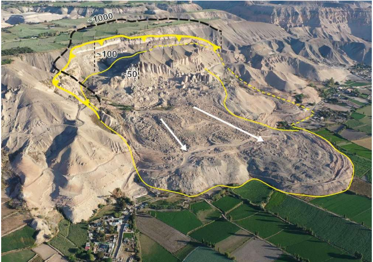
Figura 2. Vista aérea del deslizamiento de Pie de la Cuesta tomada con dron. La línea gruesa con triángulos invertidos muestra la corona del deslizamiento. La línea amarilla delgada delimita el cuerpo. La línea entrecortada delimita de forma estimada el flanco izquierdo del deslizamiento. Se observa mayor dinámica al lado derecho del deslizamiento, destacando lóbulo frontal bien desarrollado en su parte central.
